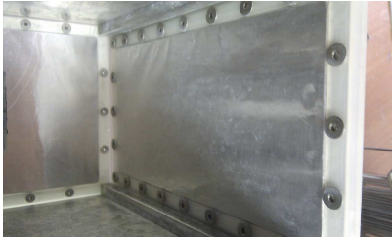
FIG.V-20 Vue de l'intérieur de la cavité équipée de parois parfaitement réfléchissante eau/air : cadre maintenant un film d'aluminium tendu.
