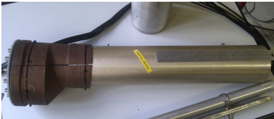
FIG.V-1 La cavité à retournement temporel solide pour l'émission d'impulsion de forte amplitude (Montaldo et al. ). A gauche, les émetteurs sont collés sur le bloc de métal. A droite, la sortie de la cavité. D'autres cavités de diamètres différents sont présentes en haut et en bas sur la photo.
