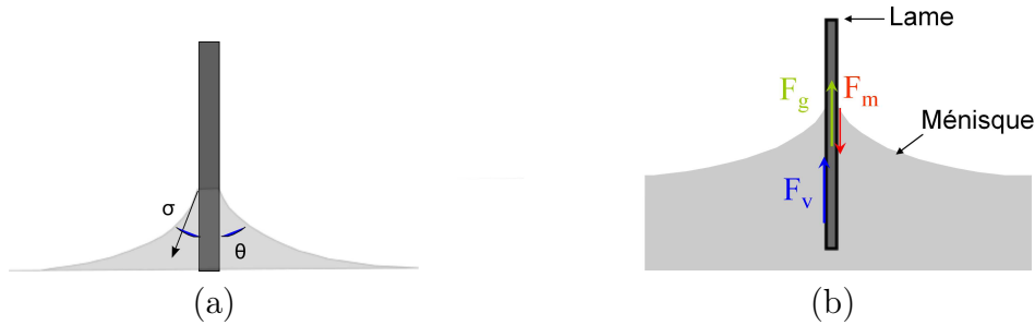
FIGURE 4.4 – (a) : Représentation de l'angle de contact et de la force de tension de surface. (b) : Bilan des forces appliquées sur une lame s'enfonçant dans un fluide. Nous désignons par F_m la force capillaire, F_g la poussée d'Archimède et F_v la force visqueuse.
