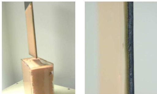
FIGURE 4.19 – Photos obtenues lors du retrait d'une plaque rugueuse à partir d'un bain d'émulsion colorée.
