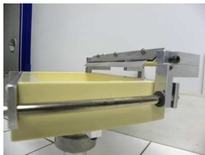
FIGURE 2.15 – Photo du système de raclage monté sur la cuve.
