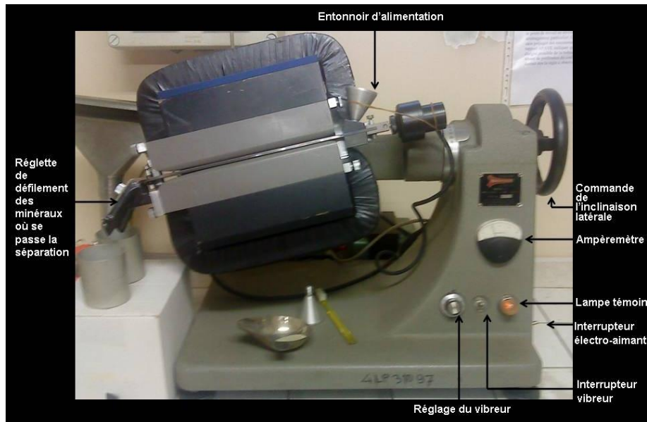
Figure 4-3 :Séparateur magnétique isodynamique Frantz pour trier la glauconite du reste de la roche totale.
