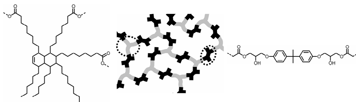
Figure 20. Réseau homogène obtenu par réaction d'estérification entre triacides carboxyliques, en gris, et de DGEBA, en noir. Chaque molécule est liée à ses voisines par des ponts \beta -hydroxylester. Les extrémités noires libres correspondent aux fonctions hydroxyles produites lors de l'ouverture des fonctions époxy.
