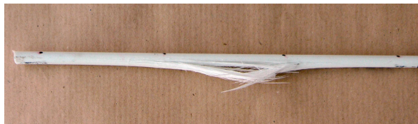
FIG. 1.2.11 – Rupture statique d'un échantillon PDion de 17cm de longueur avec des patins de protection : rupture en flexion au centre de l'échantillon
