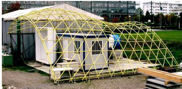
FIG. 1.4.1 – Prototype de Gridshell conçu et réalisé durant la thèse de Cyril Douthe
