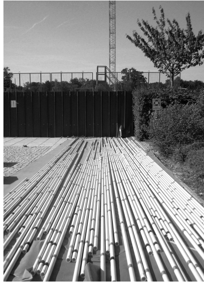
FIG. 0.0.1 – Tubes en matériau composite à fibres de verre fabriqués par pultrusion utilisés dans le projet Forum Solidays, image fournie par l'équipe de conception
