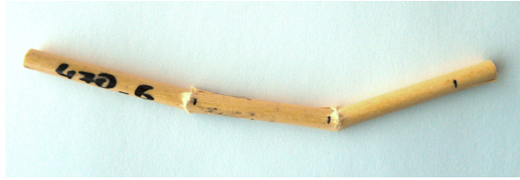
FIG. 1.2.6 – Rupture statique d'un échantillon VD470 sans patins de protection : écrasement de l'échantillon sous les appuis
