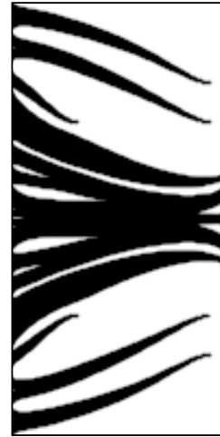
(b) Répartition de matériau hautement conducteur minimisant la moyenne de température : six branches ne sont pas reliées au flux pariétal et refroidissent uniquement le matériau faiblement conducteur.
