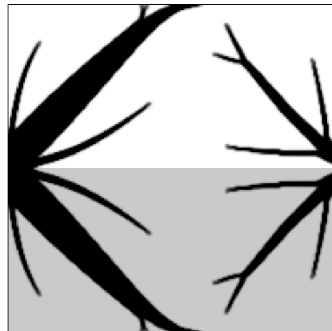
(d) Répartition de matériau hautement conducteur minimisant la température : le puits de chaleur le plus froid est relié aux flux pariétaux.
