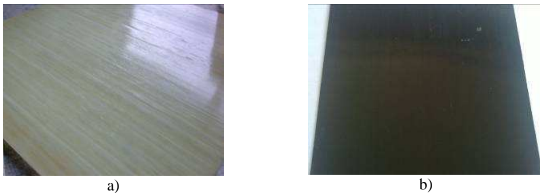
Figure 4-1. a) Composite naturel (partie transparente); b) Composite avec du noir de carbone (partie absorbante)
