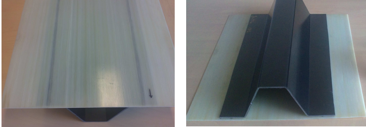
Figure 7-11. Assemblage du raidisseur sur une plaque.
