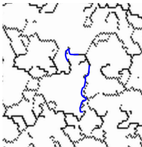
Figure D-3 : image des contours d'un joint de grain. Exemple d'une fermeture
