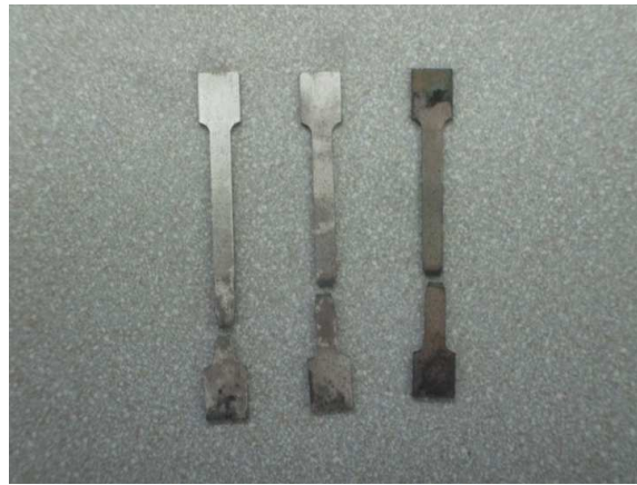
Figure 5-32 : Rupture des éprouvettes de traction à 10^{-3}\text{s}^{-1} (à gauche), 10^{-4}\text{s}^{-1} (au milieu) et 10^{-5}\text{s}^{-1} (à droite)
