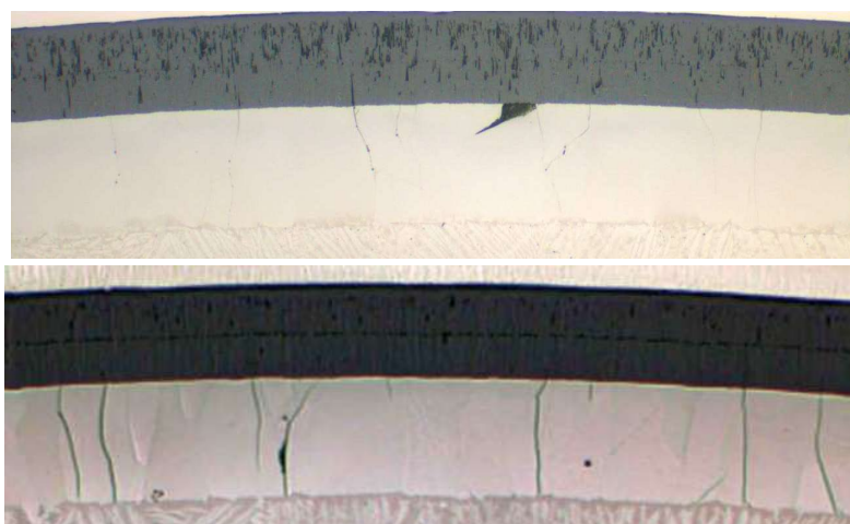
Figure 4-22 : Couches \alpha(O) et ZrO_2 de la gaine 10_1200_A_F après l'essai EDC.
