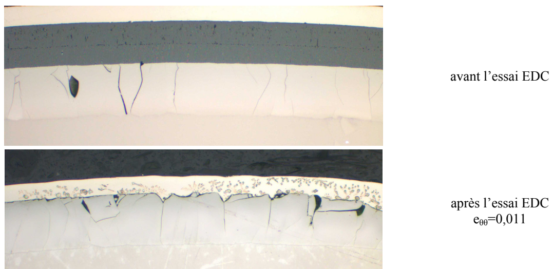
Figure 4-24 : Couches \alpha(O) et ZrO_2 du tronçon 10_1200_T_F après l'essai EDC.
