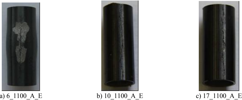
Figure 4-13 : Rupture des gaines oxydées à 1100°C puis refroidies à l'air.
