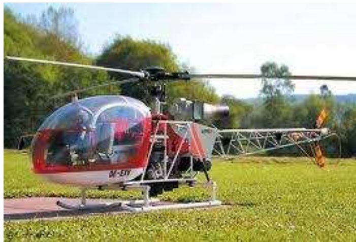
Figure 24– Hélicoptère Alouette II motorisé par un Astazou
