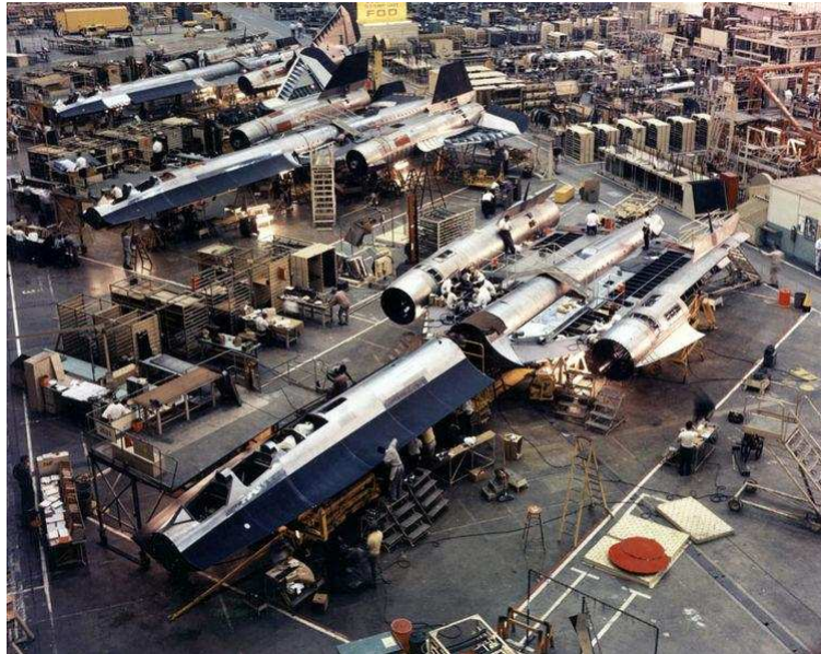
Figure 5 – Chaîne de montage du SR 71 Blackbird dans un Skunk Works
