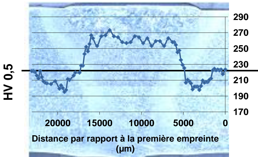
Figure 4-31 : filiation de dureté réalisée au milieu du joint soudé, à laquelle est superposée une macrographie du joint.
