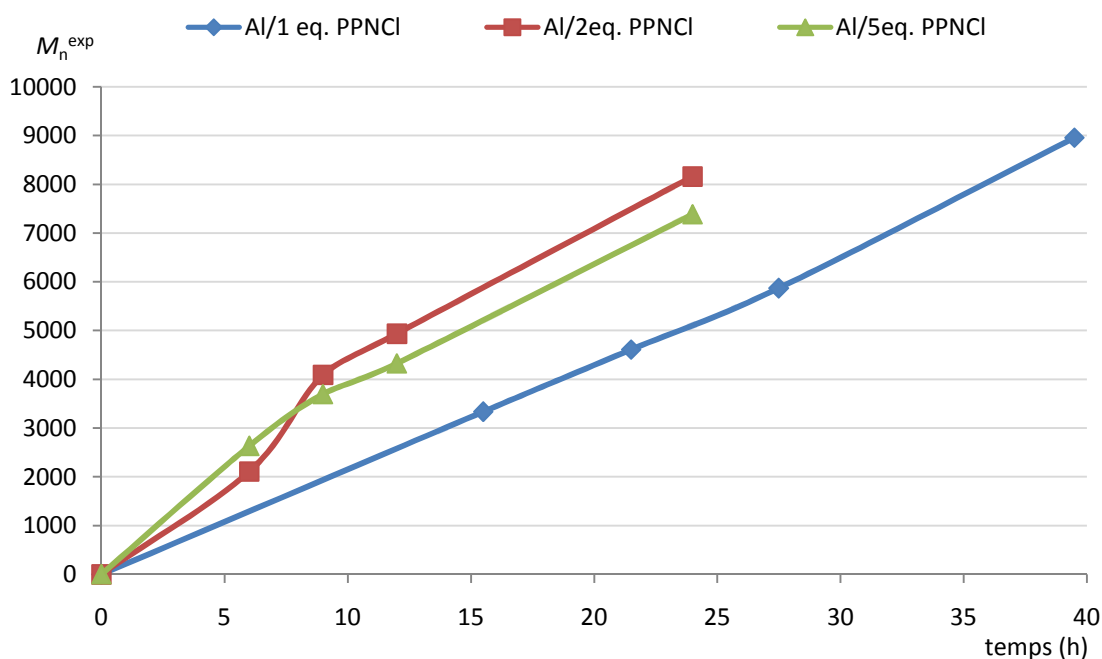
Figure 54 : Masses obtenues en fonction du temps avec différentes proportions de co-catalyseurs a
