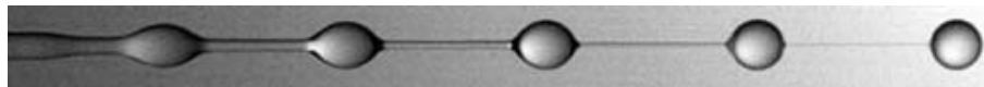
(a) Structure en collier de perles ou beads-on-a-string adoptée par un jet d'une solution aqueuse diluée de polyacrylamide
