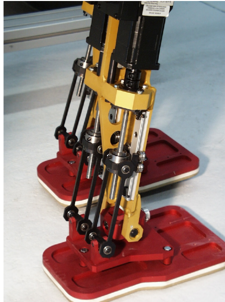
FIGURE 1.11 – Cinématique des chevilles du robot BIP [66].
