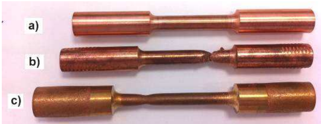
Figure II.3.7 (a) Eprouvette de traction initiale, (b) éprouvette en cuivre étiré après essai de traction et (c) éprouvette en cuivre laminé après essai de traction
