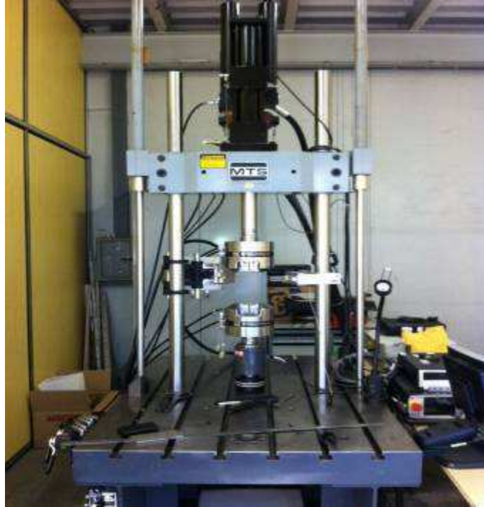
Figure II.3.3 Machine de traction servo-hydraulique MTS utilisée pour les essais de traction
