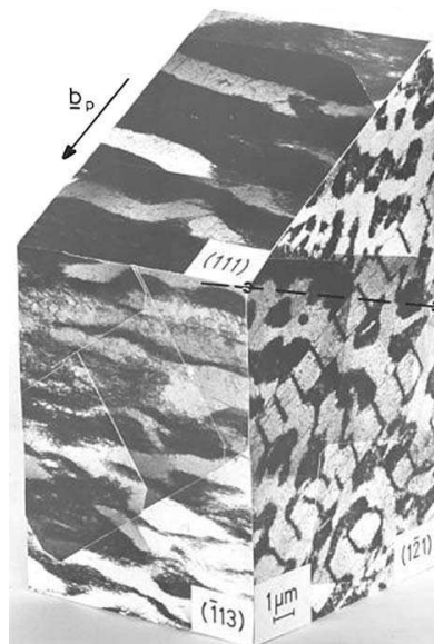
Figure I.3.17. Montage 3-D par MET de structures en échelle des PSB et de structure en veine de la matrice dans du cuivre monocristallin correspondant à la région B de la courbe CSS \gamma_{pl}=1.5 \times 10^{-3} , \tau_s=28 MPa) [Mughrabi 79]
