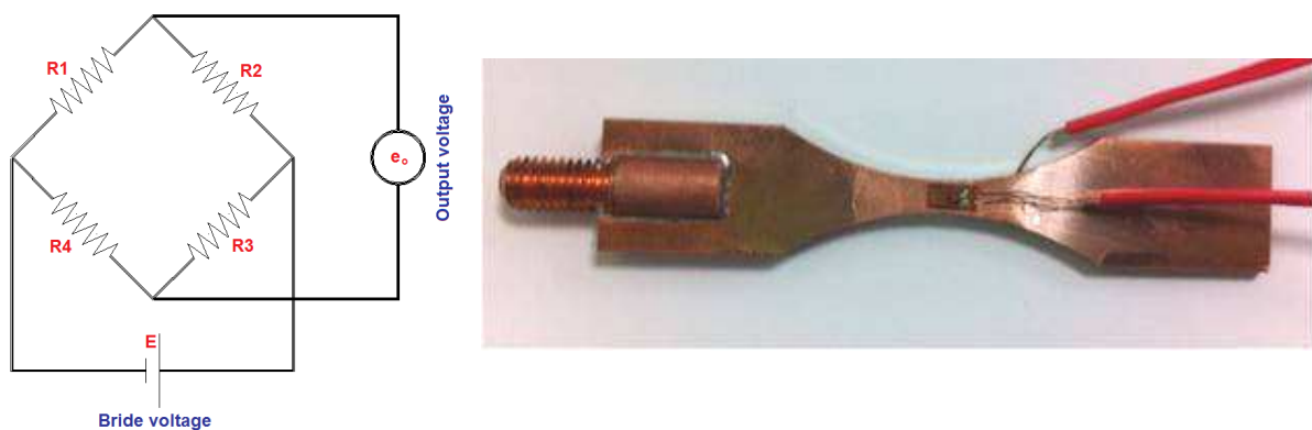
Figure III.1.21 Pont de Wheatstone est l'éprouvette avec 2 jauges R1 et R3 aux 2 côtés
