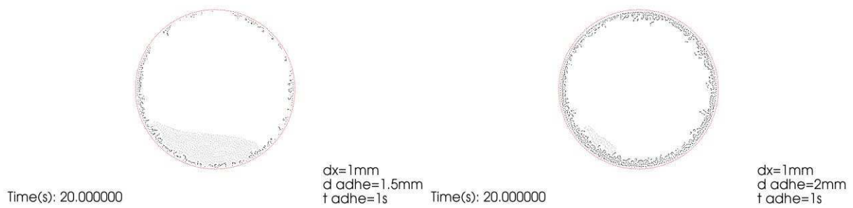
Figure 71 : Influence de d_{adhe} sur le processus d'adhésion pour dx=1mm . Le moule est représenté en rouge, le fluide en gris et la matière adhéree en noir.
