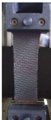
Figure II-15 Test bias : Eprouvette avant déformation
