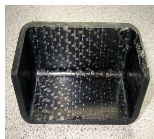
Figure I-1 : à droite description d'un composite A gauche: exemple d'une pièce composite à renfort textile
