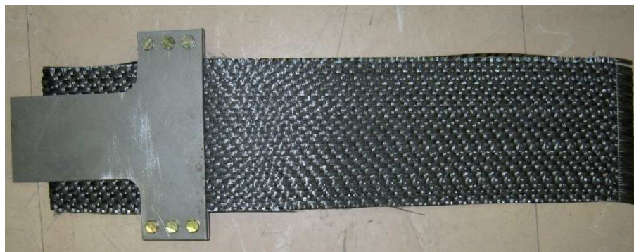
Figure IV-7 : Eprouvette de G1151 utilisé pour le test de frottement
