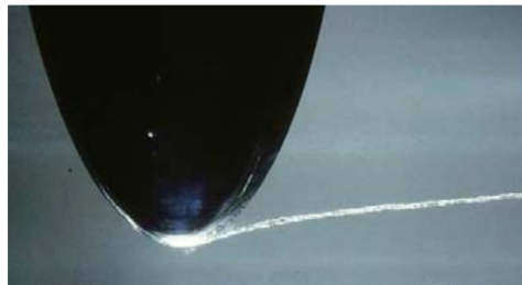
FIGURE 2.3 – Cavitation par filaments tourbillonnaires, [Franc, 2005]
