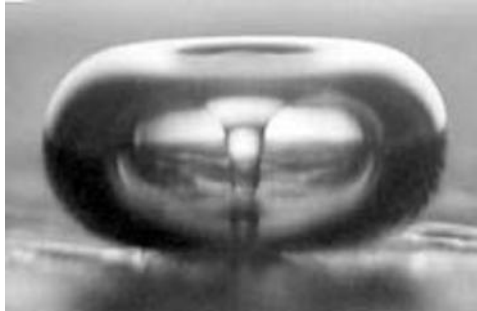
FIGURE 2.8 – Capture du collapse d'une bulle de vapeur
