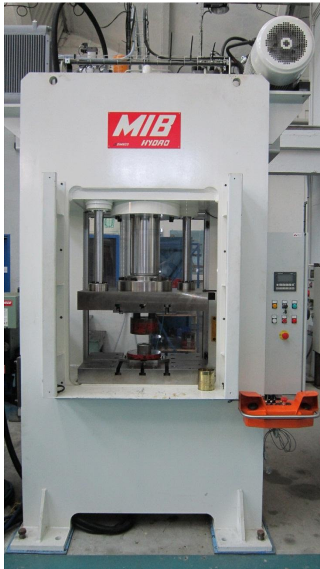
Figure C-1 : Presse utilisée dans les essais de poinçonnage
