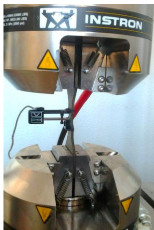
Figure II-11 : Exemple de montage d'une éprouvette entaillée sur la machine de traction
