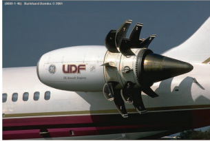
FIGURE 1.3: Moteur UnDucted Fan développé par GE sur un MD-80 (1987)
