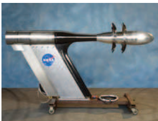
FIGURE 1.6: Montage d'essai de la NASA avec pales GE testé au Glenn Research Center. Source : nasa.gov
