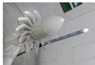
FIGURE 1.8: Banc d'essai Hera testé à S1 modane avec instrumentation pour les mesures acoustiques © Snecma
