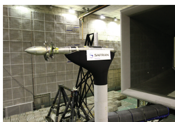
FIGURE 1.7: Banc d'essai Hera testé au DNW © Snecma
