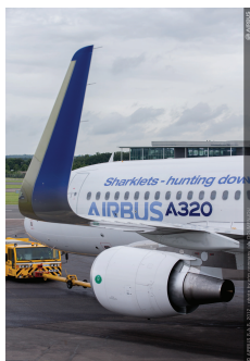
FIGURE 2.9: Sharklets de l'A320 (www.airbus.com)
