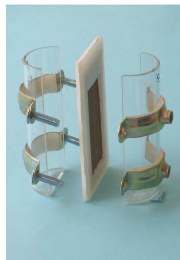
Figure 2.5. : cellule en position de montage
