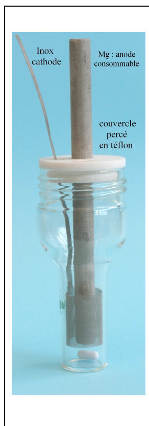
Figure 2.1 : cellule sans compartiments séparés Filetage SVL 42 mm
