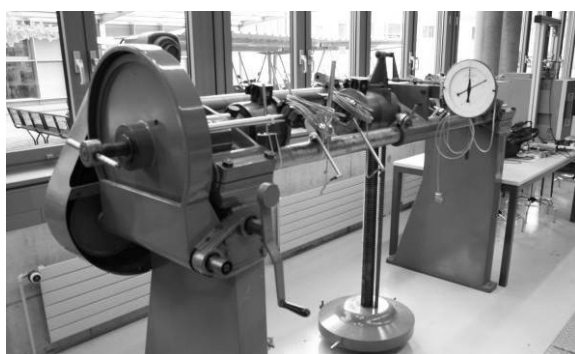
Fig. 10 : Machine d'essai de torsion de type Amsler et prisme après essai de torsion.
