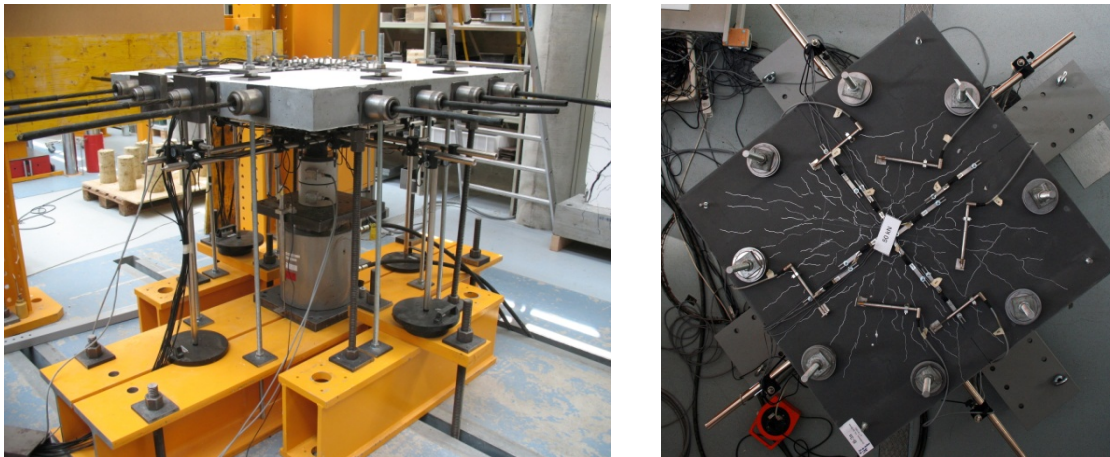
Figure 3: Essai de poinçonnement sur les dalles en BFHP et en BFUP
