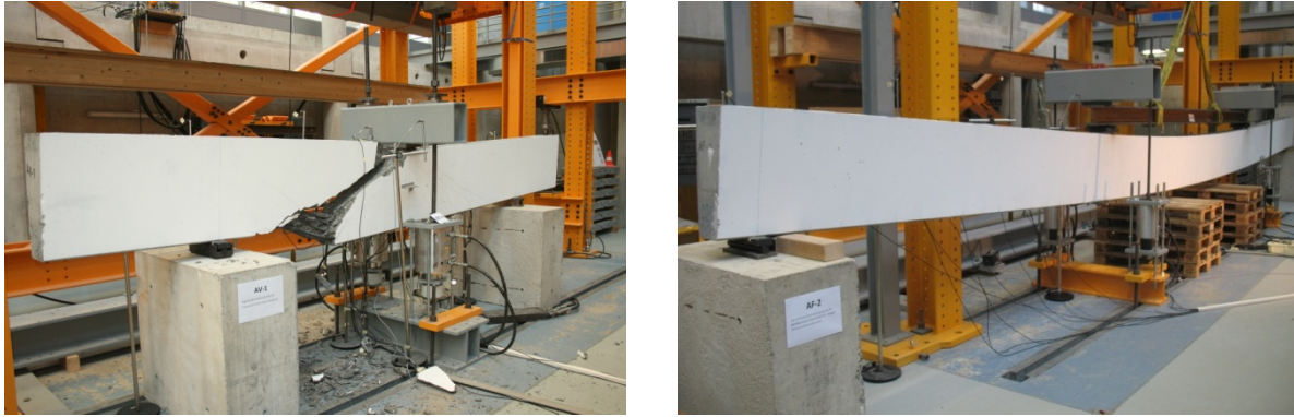
Figure 1: Essais de charge sur les poutres courtes et longues en BFHP
