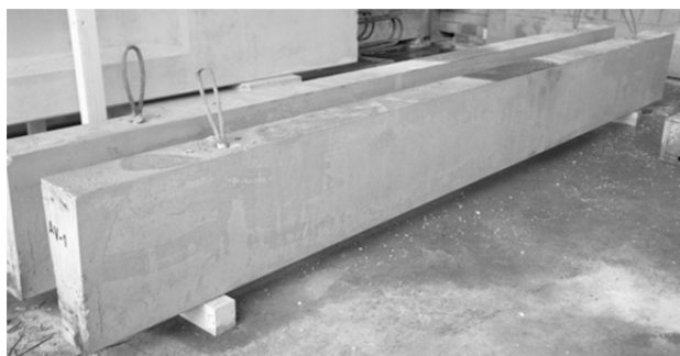
Figure 19 : Eléments AV après décoffrage
