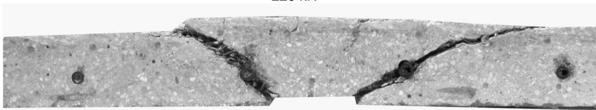
Fig. 105 : Fissuration à plusieurs niveaux de charge et fissures internes de la dalle B5-04.
