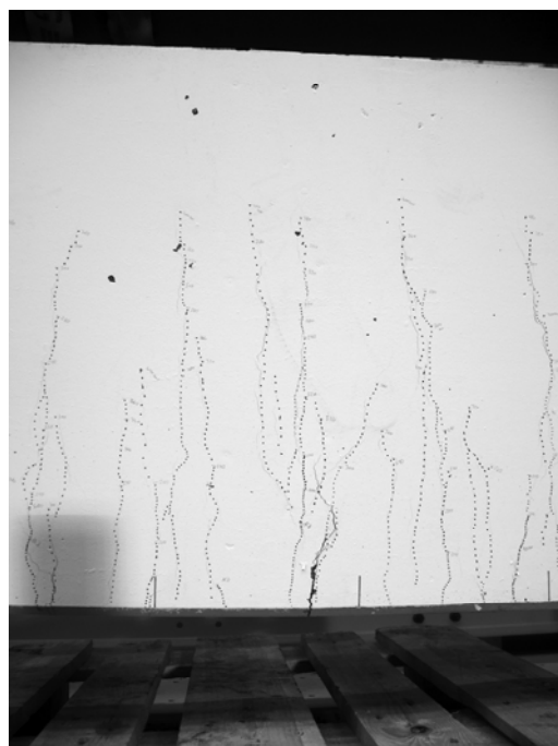
Figure 53 : Multi-fissuration de flexion et localisation sur une seule macro-fissure
