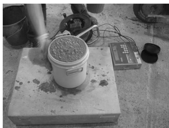
Figure 9 : Essai d'étalement Slump flow et mesure de la masse volumique
