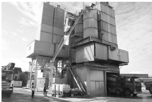
Figure 6 : Centrale à béton et transport du béton
