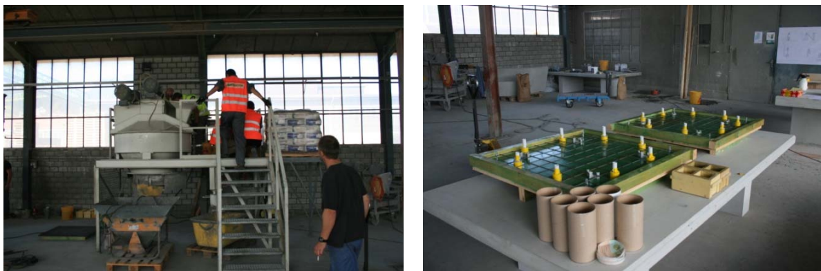
Figure 1-2 : Malaxeur Kniele et coffrages des dalles
