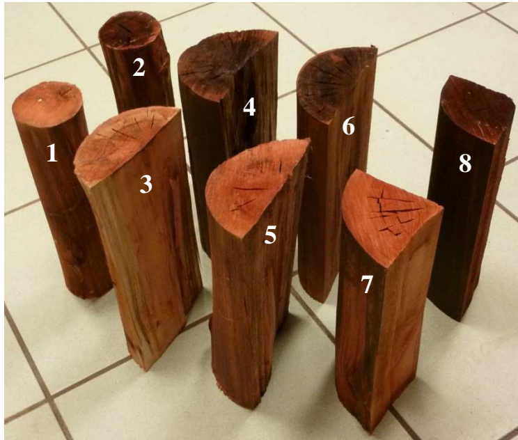
Figure 153 : Aspect des échantillons d'eucalyptus en fin de séchage à 110 °C (devant) et à 160 °C (derrière)
