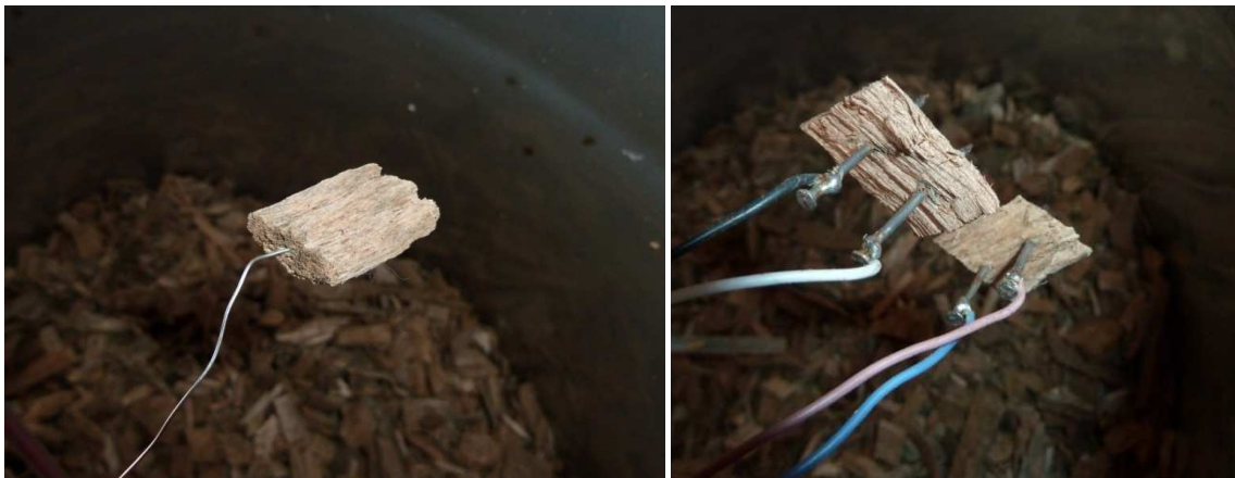
Figure 75 : Instrumentation des plaquettes : mesure de la température (à gauche) et de la résistance électrique du bois (à droite)
