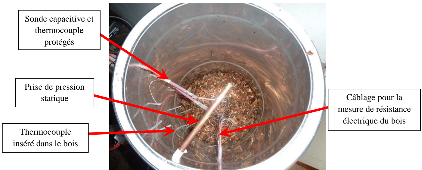
Figure 74 : Passages de paroi pour instrumenter le lit fixe
