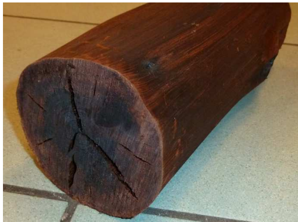
Figure 36 : Fentes d'un billon d'eucalyptus séché à 160 °C
