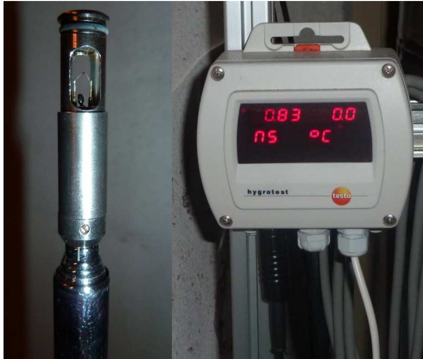
Figure 73 : Vélocimètre : sonde à fil chaud à gauche et transmetteur à droite
