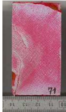
Figure 95 : DV12-10MPa-90°C après la rupture
