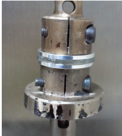
FIGURE 3.10 – Éprouvette de poix synthétique S1 après une dernière mise en pression sur le rhéomètre.
