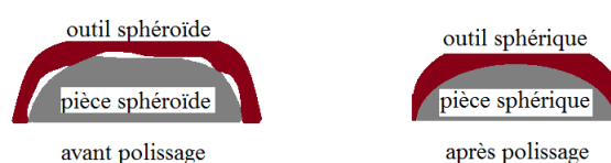
FIGURE 2.17 – Lissage naturel par frottement de deux pièces sphéroïdes l'une sur l'autre pendant une durée infinie.
