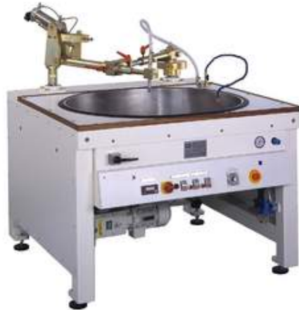
FIGURE 2.14 – Machine de polissage traditionnel utilisée pour l'étape de lissage.
