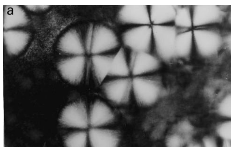
Figure 1-12 : Observation micrographique d'un film de PA 6,6. Mise en évidence de sphérolites [23].
