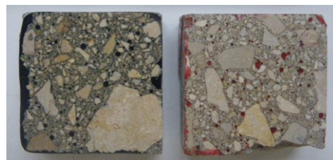
Figure A. 19 Échantillons imprégnés à la résine colorée
