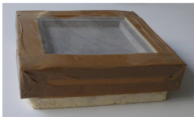
Figure 2.73 Capots isolants pour les corps d'épreuve cubiques
