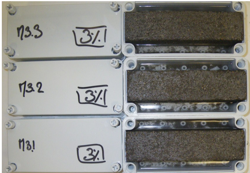
Figure 2.75 Corps d'épreuve immergés en cours d'essai
