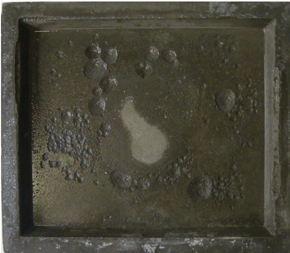
Figure 3.12 Corps d'épreuve de la série C.c.1.(12)-0,44-1-0-0 après 28 cycles d'exposition
