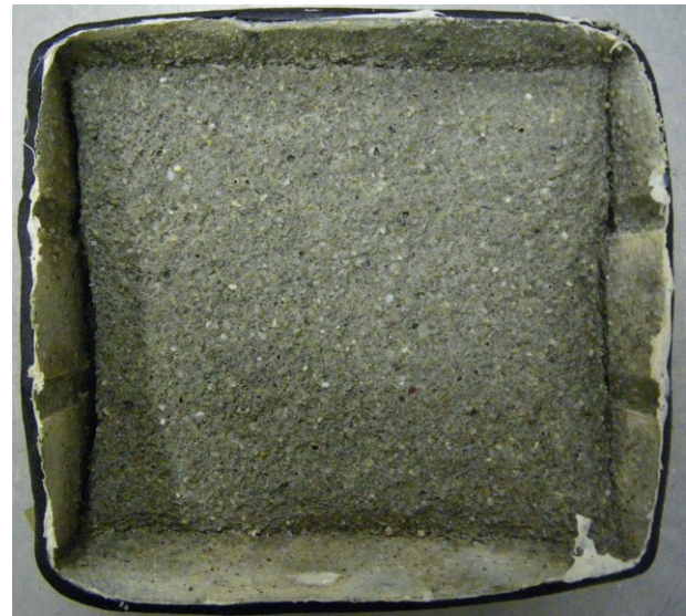
Figure 2.70 Corps d'épreuve en mortier après 299 cycles d'écaillage, face inférieure
