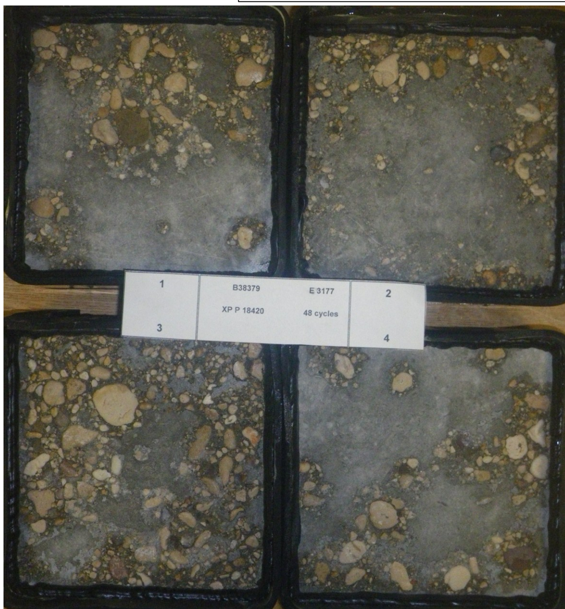
Figure A. 44 Formule B1 –Essai 3177 – Résultats et illustration des corps d'épreuve à 49 cycles
