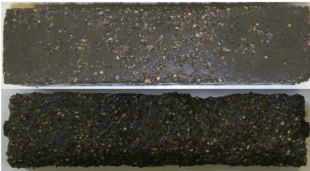
Figure 2.98 Prisme de la série M.p.4.(6x3)-0,44-0-1-1 exposé à 181 cycles et 0% de NaCl (en haut), 156 cycles et 3% de NaCl (en bas)
