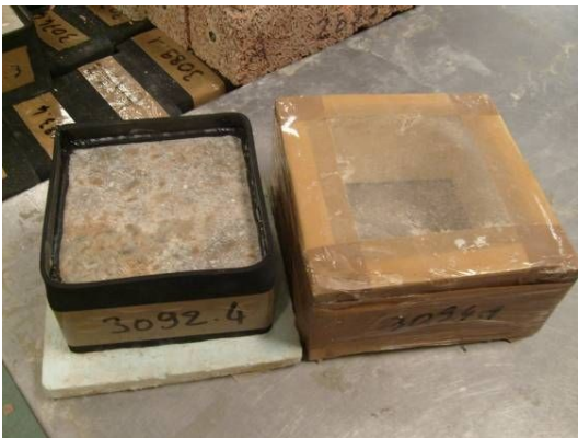
Figure A. 33 Illustration d'une éprouvette et de son capot isolant.
