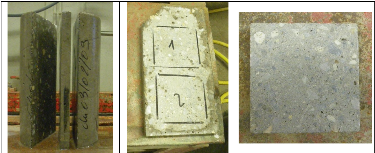
Figure A. 11 Découpe des plaques d'essai dans un cylindre 16x32
