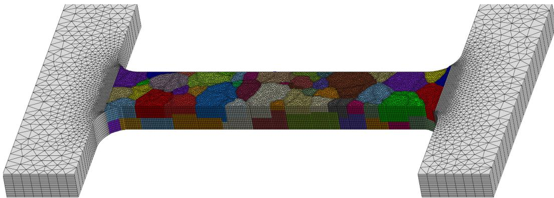
FIGURE 4.10 – Maillage 3D obtenu à partir du scan EBSD des deux surfaces : 194 304 éléments prismatiques linéaires à base triangulaire (c3d6), 327 327 degrés de liberté.
