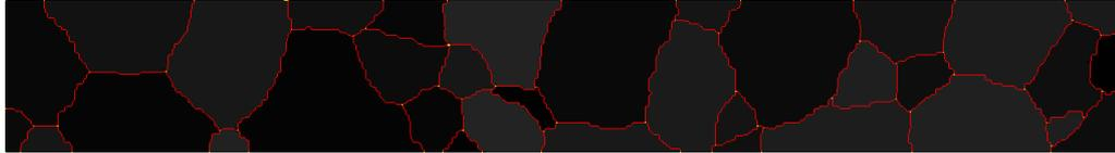
FIGURE 4.4 – Détection des contours des ex-grains  $\beta$ .
