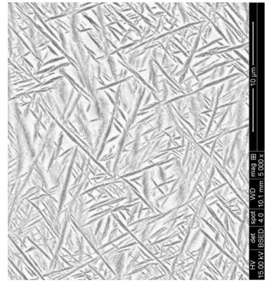
Traitement thermique : | 890°C - 30 min |, | Trempe |, | 620°C - 1h30 |, | Trempe |.
