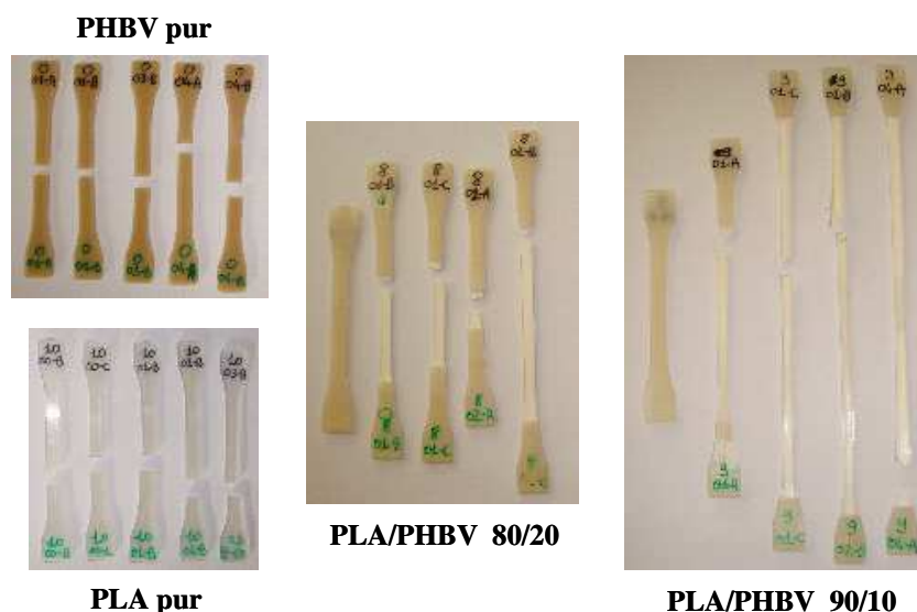
Figure V.29 : Aspect d'éprouvettes de traction après l'essai mécanique pour différentes compositions de mélanges PLA/PHBV
