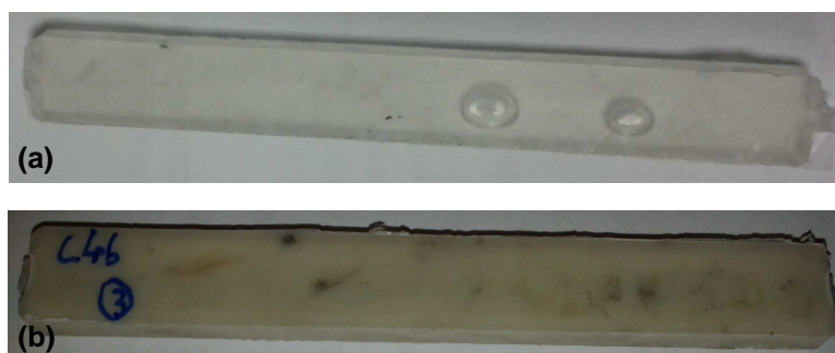
Figure V.1 : Défauts présents sur les barreaux de choc réalisés par compression : (a) bulles d'air dans un barreau de PLA pur ; (b) inhomogénéités dans un barreau de mélange PLA/PHBV
