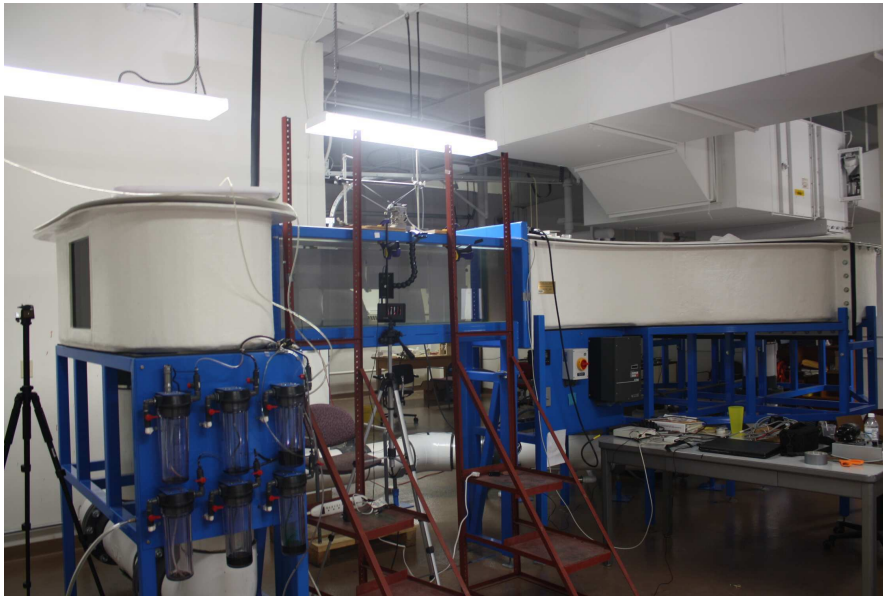
FIGURE 3.3 – Canal hydraulique utilisé pour mener l'étude expérimentale des VIV de corde suspendue.
