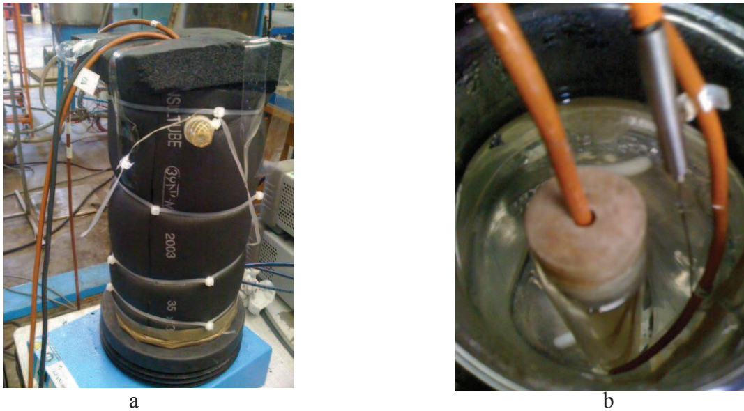
Figure C. 2. Images réelles du calorimètre: a) Vue calorimètre en marche; b) Vue intérieur du calorimètre
