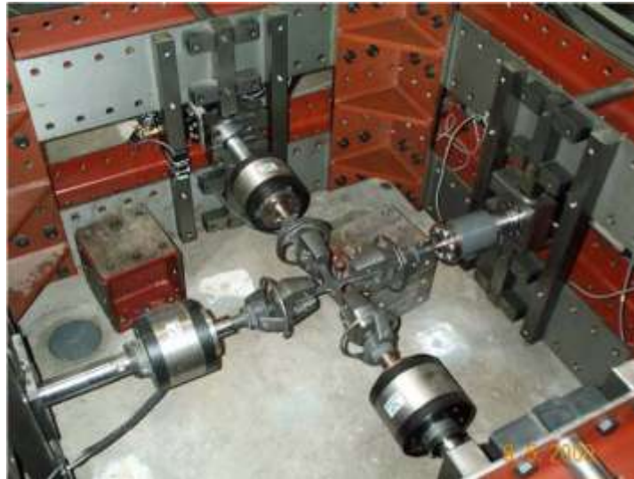
Figure 2-10 : Machine d'essai biaxiale utilisée par Smits et al. 2006.
