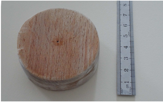
(a) Capillaire unique de diamètre D_1 = 1025\mu\text{m} \pm 2,3\mu\text{m}
