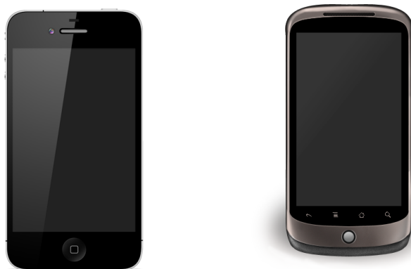
FIGURE 1.1: Exemples de Smartphones : iPhone 4 et Google Nexus One. Comme on peut le constater ces deux modèles ont un écran tactile mais ne possèdent plus de clavier physique. Ils comportent seulement un nombre limité de boutons réservés à des tâches spécifiques.
