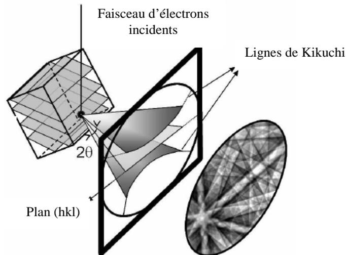
Figure II-7. Principe de formation des lignes de Kikuchi en EBSD (Baudin and Etter, 2008)
