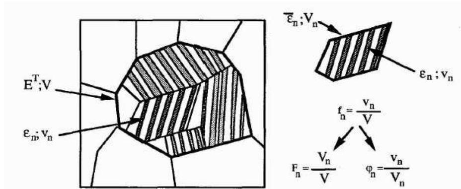
Figure A4-3. Aspects microstructuraux du modèle de type "cluster" employé pour la détermination de l'énergie d'interaction dans un grain (Patoor et al., 1996b).
