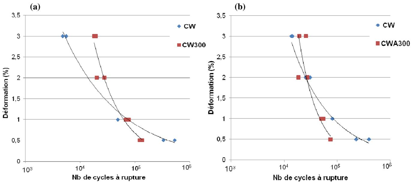
Figure A1-2. Courbes déformation en fonction du nombre de cycles à rupture à l'état CW et CWA300 pour les deux alliages étudiés : (a) Ti-26Nb et (b) Ti-24Nb.
