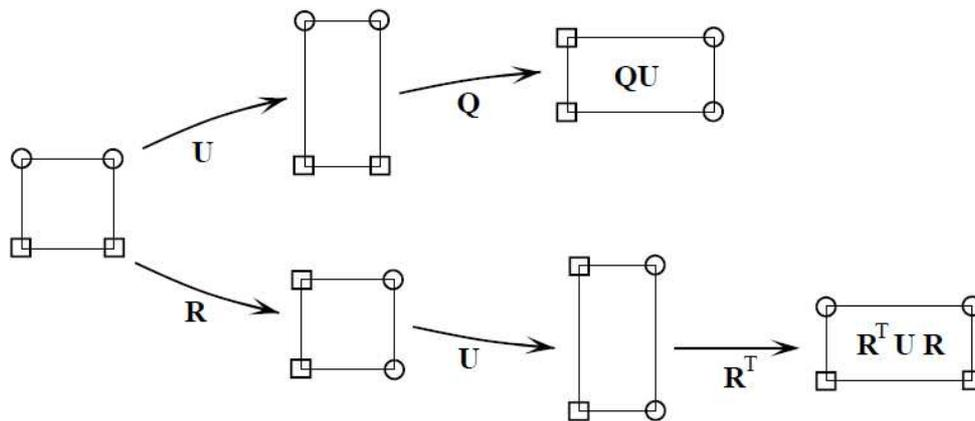
Figure A3-2. Différence entre les rotations considérées dans la symétrie du matériau et l'invariance du réseau.
