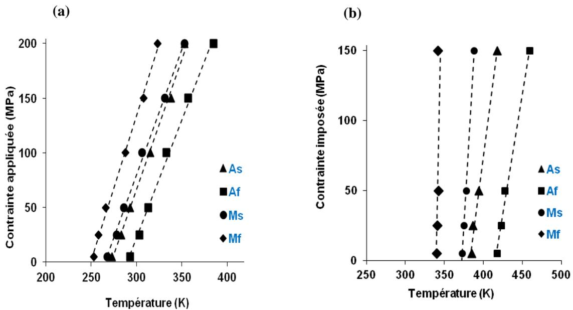
Figure III-23. Variation des températures de transformation en fonction de la contrainte pour (a) Ti-26Nb et (b) Ti-24Nb.
