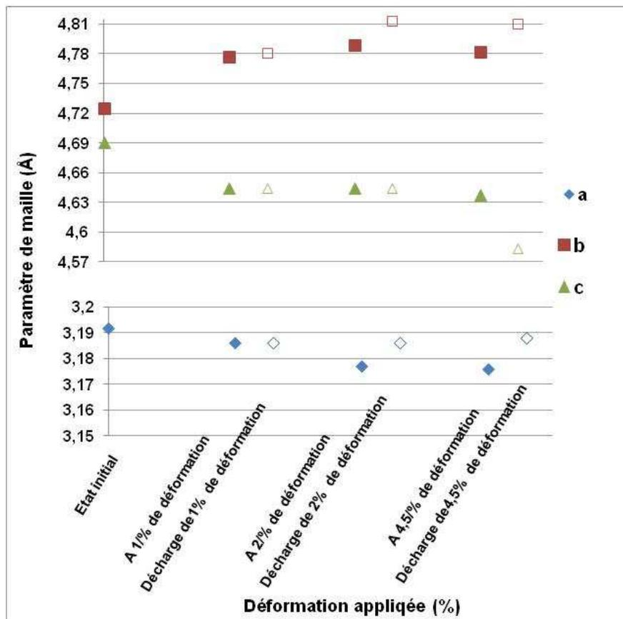
Figure IV-25. Evolution des paramètres de maille de la phase martensitique au cours du chargement cyclique.
