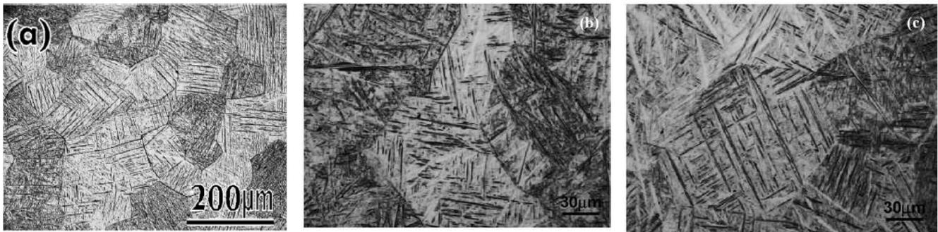
Figure I-5. Micrographies optiques des quelques alliages de titane (a) Ti-25Nb (b) Ti-24Nb-4Zr-3.5Sn, (c) Ti-20Nb-4Zr-7.5Sn (en %mass.) (Hao et al. 2006) après une trempe montrant la morphologie de la phase  $\alpha'$ .
