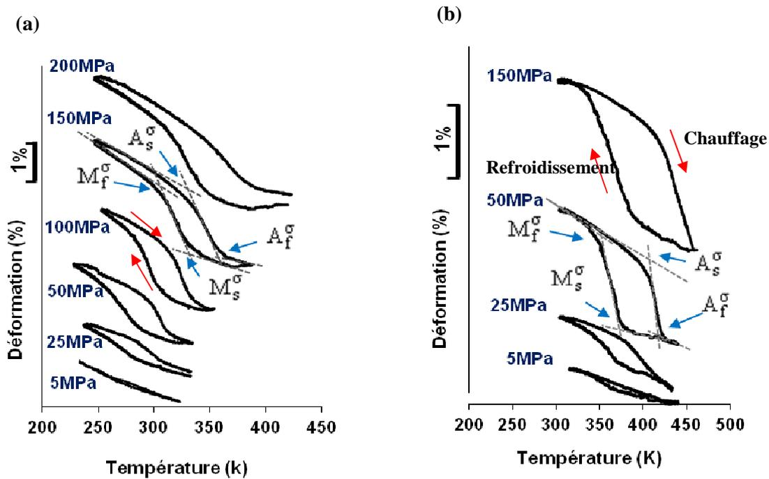
Figure III-22. Courbes déformation en fonction de la température pour (a) Ti-26Nb et (b) Ti-24Nb.
