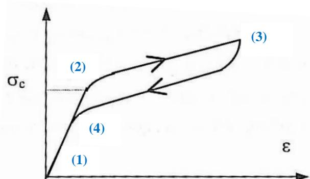
Figure I-12. Effet superélastique d'un échantillon polycristallin.
