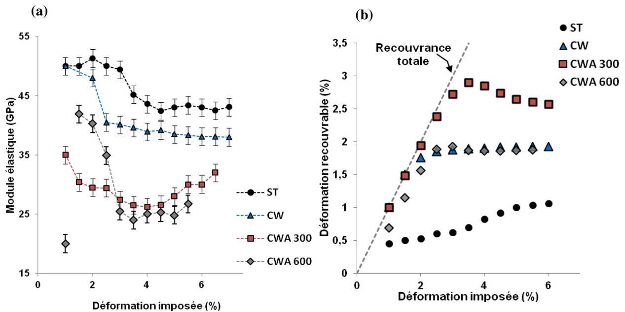
Figure V-14. Evolution des propriétés: (a) module apparent d'élasticité et (b) déformation recouvrable après chargement en traction de l'alliage Ti-24Nb pour les états ST, CW, CWA<sub>300</sub> et CWA<sub>600</sub>.
