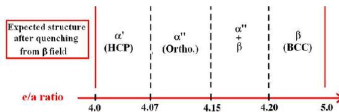
Figure III.3. Relation entre la valeur de  $e/a$  et les microstructures de trempe traduisant la stabilité de la phase  $\beta$  (Laheurte et al., 2010).
