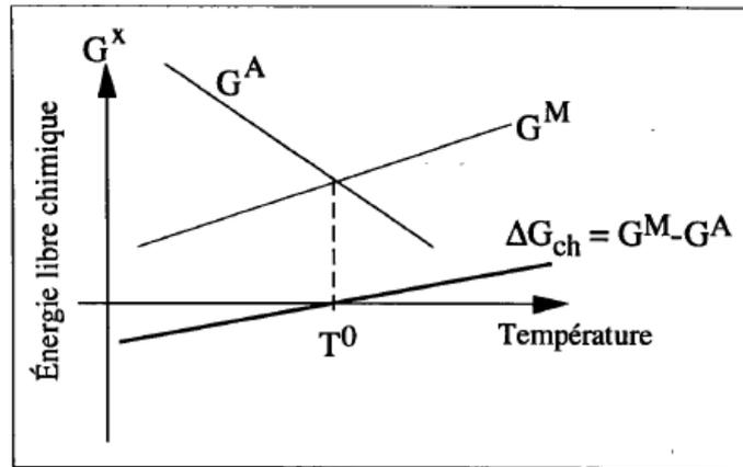
Figure A4-2. Représentation schématique l'énergie chimique des deux phases austénitique et martensitique.
