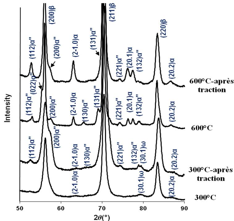
Figure V-12. Diffractogrammes réalisés à l'état  $CWA_{300}$  et  $CWA_{600}$  après rupture en traction pour l'alliage Ti-24Nb. Comparaison avec ceux réalisés avant déformation.
