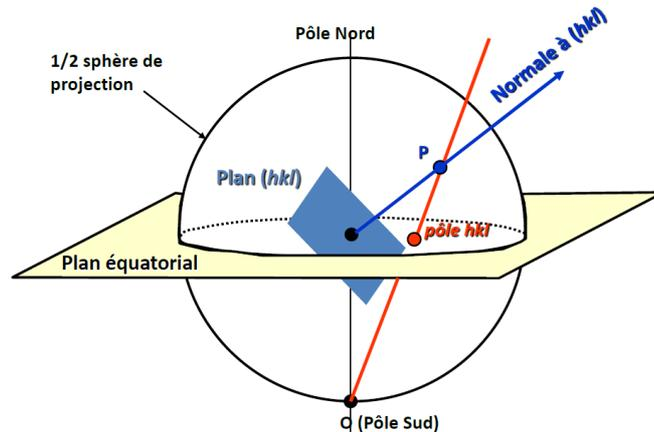
Figure II- 6. Schéma illustrant la construction de la figure de pôle.
