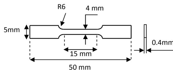
Figure IV-3. Dimensions de l'éprouvette de traction.
