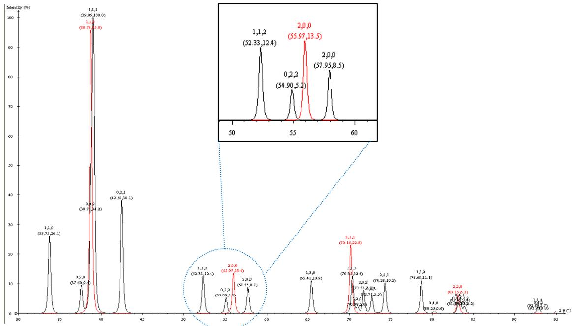
Figure III-17. Diffractogramme simulé à l'aide de Carine superposant les deux phases  $\beta$  et  $\alpha$ ".
