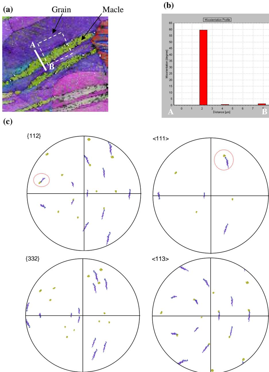
Figure IV-12. Identification du système de maclage  $\{112\}_\beta \langle 111 \rangle_\beta$  : (a) cartographie EBSD sur un grain, (b) profil de désorientation suivant la ligne AB et (c) figures de pôle  $\{112\}_\beta$ ,  $\{332\}_\beta$ ,  $\langle 111 \rangle_\beta$  et  $\langle 113 \rangle_\beta$ .
