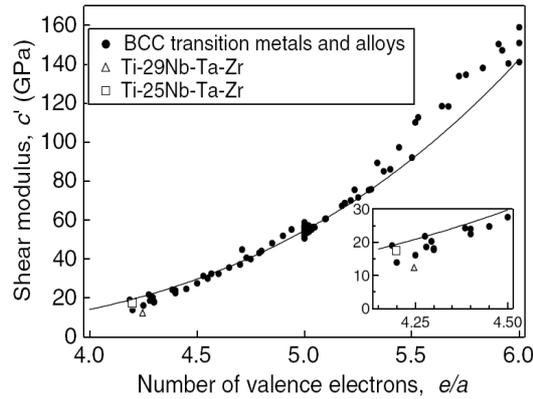
Figure III-5. Module de cisaillement  $C'$  du Ti-29Nb-Ta-Zr, Ti-25Nb-Ta-Zr, différents métaux de transition de structure cubique centrée et alliages binaires en fonction de  $e/a$  (Tane et al. 2008).
