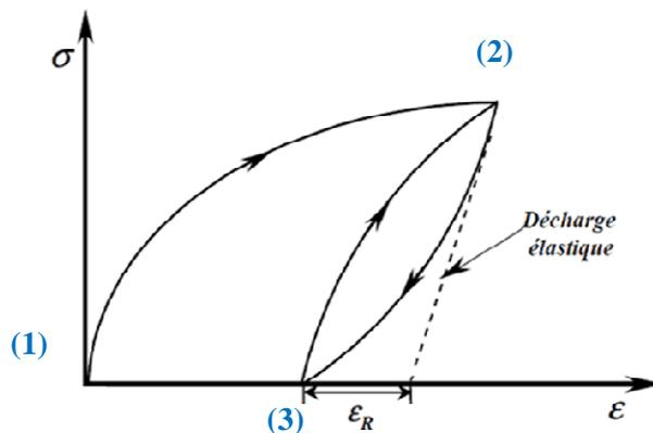
Figure I-15. Effet caoutchoutique associé au mouvement réversible des interfaces entre variantes de martensite.
