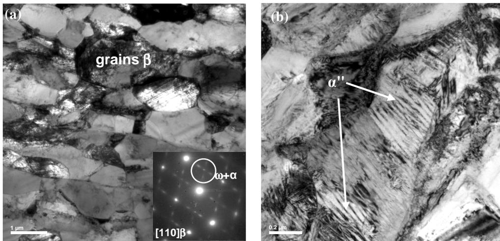
Figure V-9. Images MET de l'alliage Ti-26Nb après un traitement thermique à 600°C pendant 10 min: (a) image en champ clair montrant des grains  $\beta$  très fins et le cliché de diffraction selon l'axe de zone  $[110]_{\beta}$  et (c) image en champ clair montrant la présence de la phase  $\alpha'$ .
