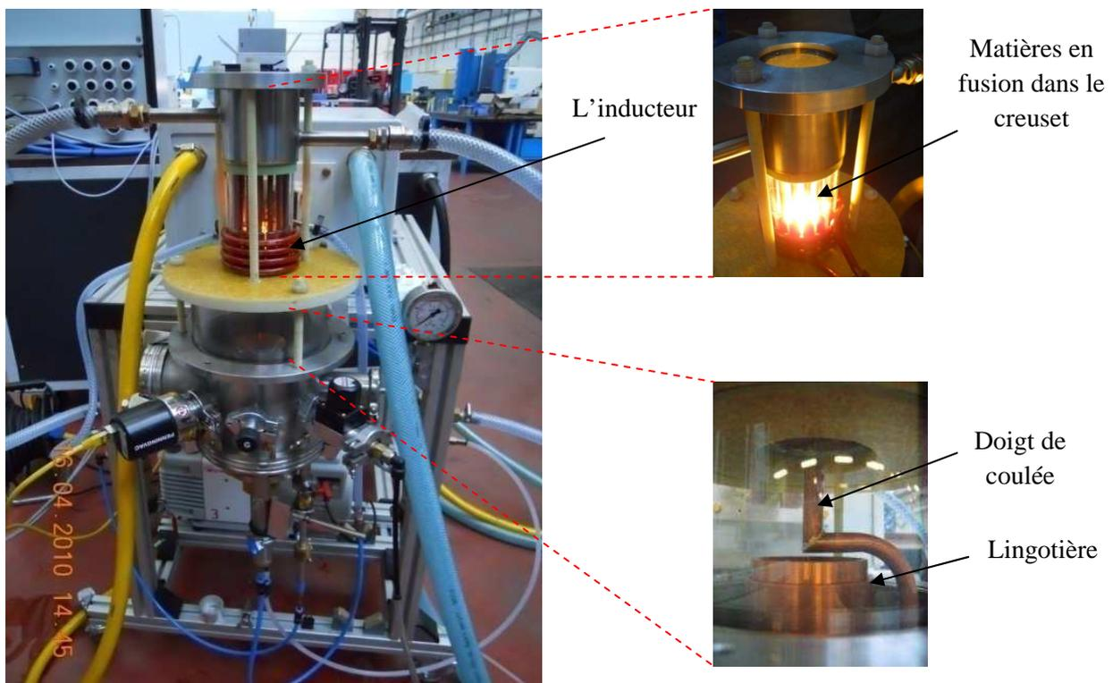
Figure II-1. Dispositif du four à induction en semi-lévitation magnétique.
