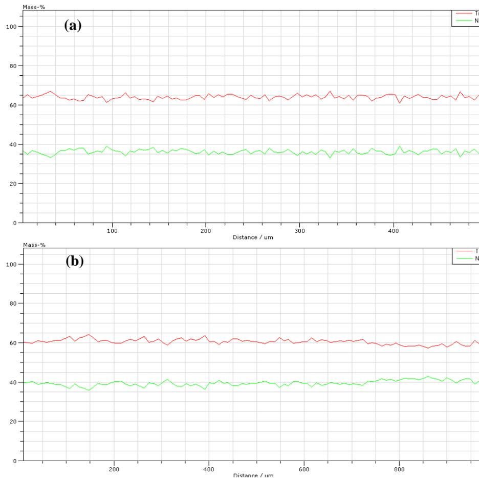
Figure III-14. Profils de concentration obtenus pour (a) Ti-24Nb et (b) Ti-26Nb.
