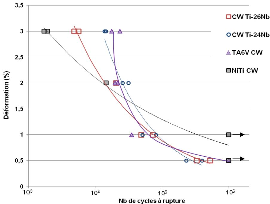
Figure A1-3. Comparaison des résultats des essais de fatigue des deux alliages binaires Ti-24Nb et Ti-26Nb à ceux du NiTi et TA6V.
