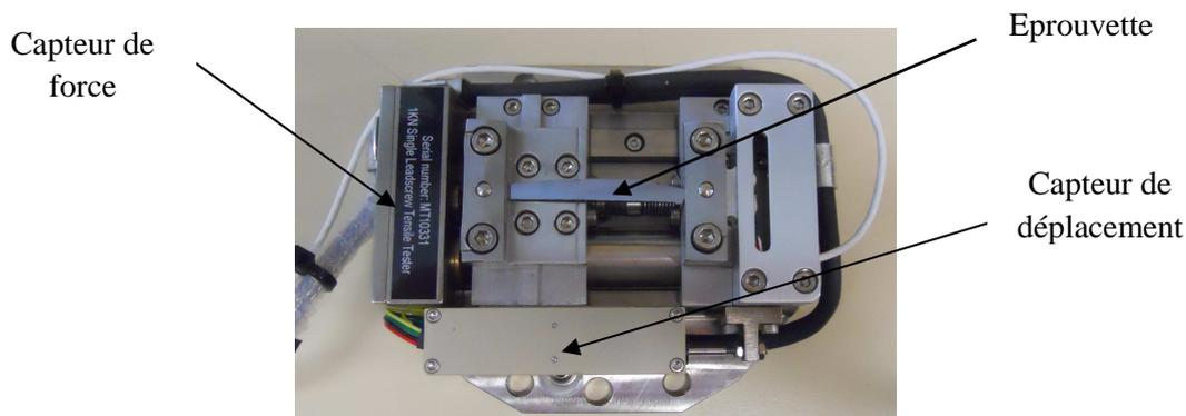
Figure IV-2. Machine de traction utilisée pour l'essai in-situ
