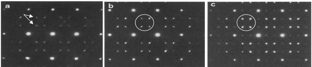
Figure I-3. Clichés de diffraction d'un alliage Ti-36Nb (%mass.) à l'état trempé (a), vieilli à 300°C-1.2ks (b) et vieilli à 300°C-10.8ks(c) (Hanada *et al.*, 1985).
