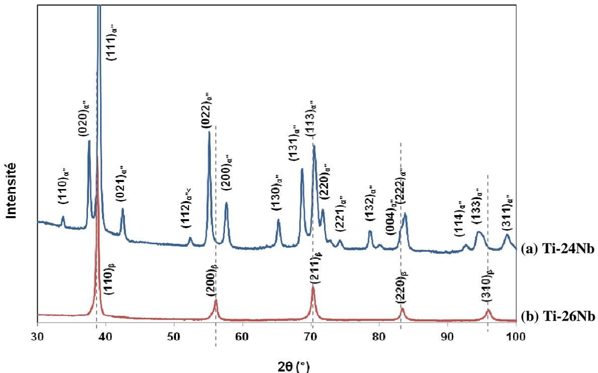
Figure III-16. Diffractogrammes obtenus pour les deux alliages à l'état trempé.
