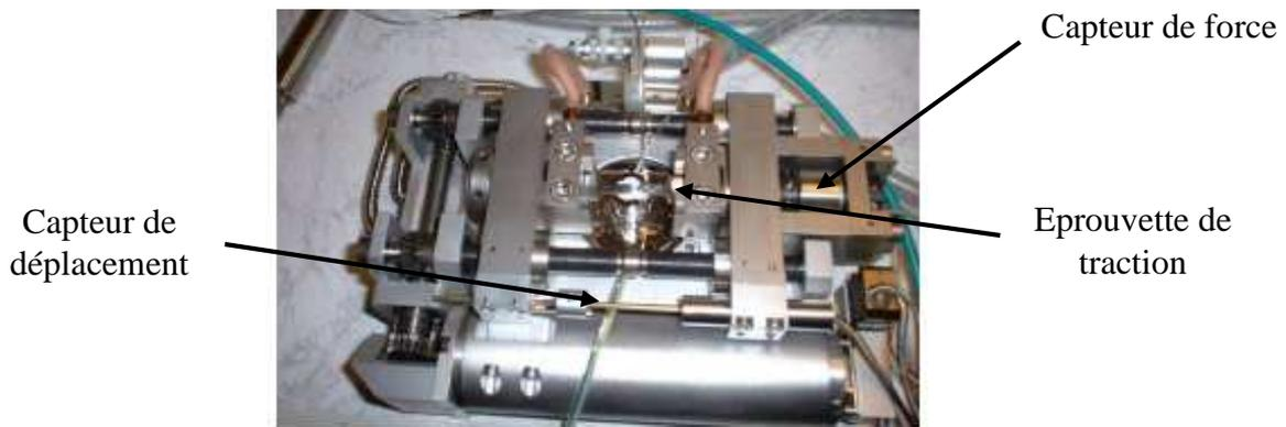
Figure IV-18. Machine de traction utilisée pour l'essai in-situ.
