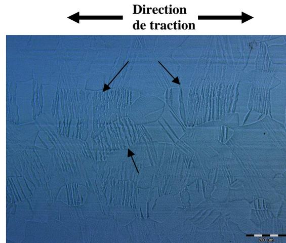
Figure IV-8. Micrographies après 10% déformation en traction pour l'alliage Ti-26Nb.
