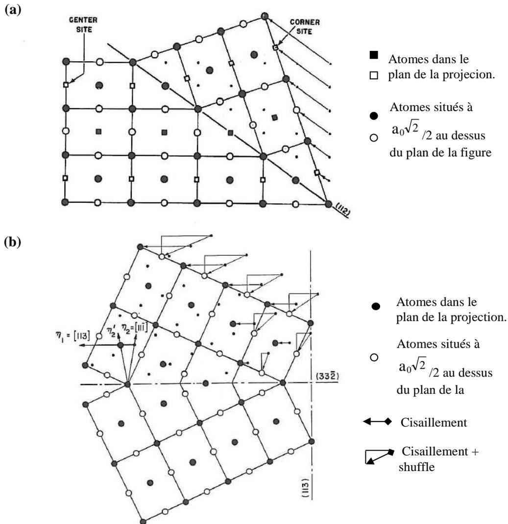
Figure IV-7. Système de maclage (a)  $\{112\}_\beta <111>_\beta$  et (b)  $\{332\}_\beta <113>_\beta$  dans le plan de projection  $(110)$  (Richam, 1964).
