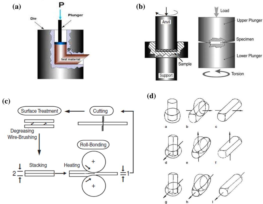
Figure I-21. Différentes méthodes de déformation plastique sévère : (a) ECAP "Equal-Channel Angular Pressing", (b) HPT "High Pressure Torsion" (c) ARB "Accumulative Roll Bonding" et (d) MDF "Multi-Directional Forging". (Valiev et al., 2006).
