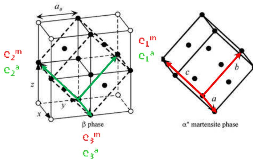
Figure VI-6. Représentation schématique de la transformation martensitique d'une structure CC à une structure orthorhombique.
