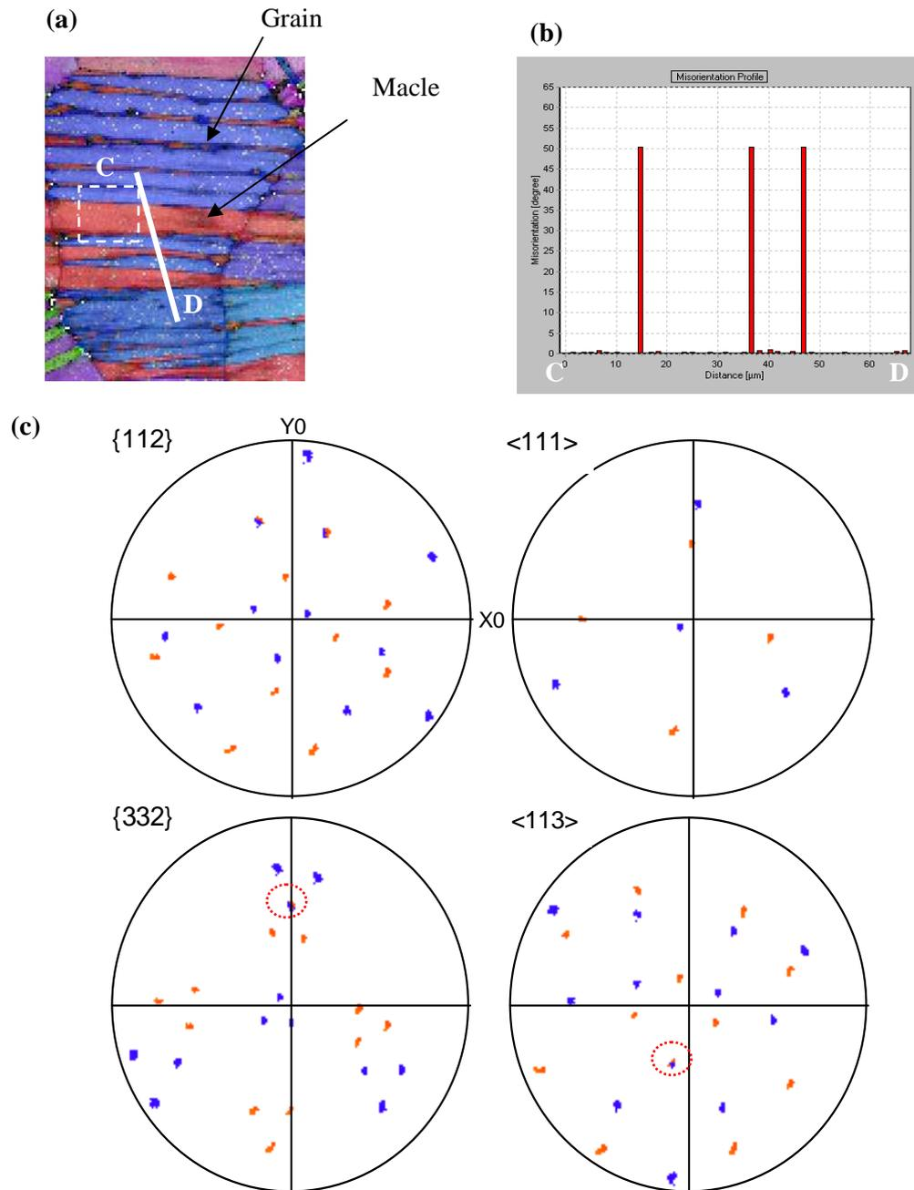
Figure IV-13. Identification du systèmes de maillage  $\{332\}_\beta \langle 113 \rangle_\beta$  : (a) cartographie EBSD sur un grain, (b) profil de désorientation suivant la ligne AB et (c) figures de pôle  $\{112\}_\beta$ ,  $\{332\}_\beta$ ,  $\langle 111 \rangle_\beta$  et  $\langle 113 \rangle_\beta$
