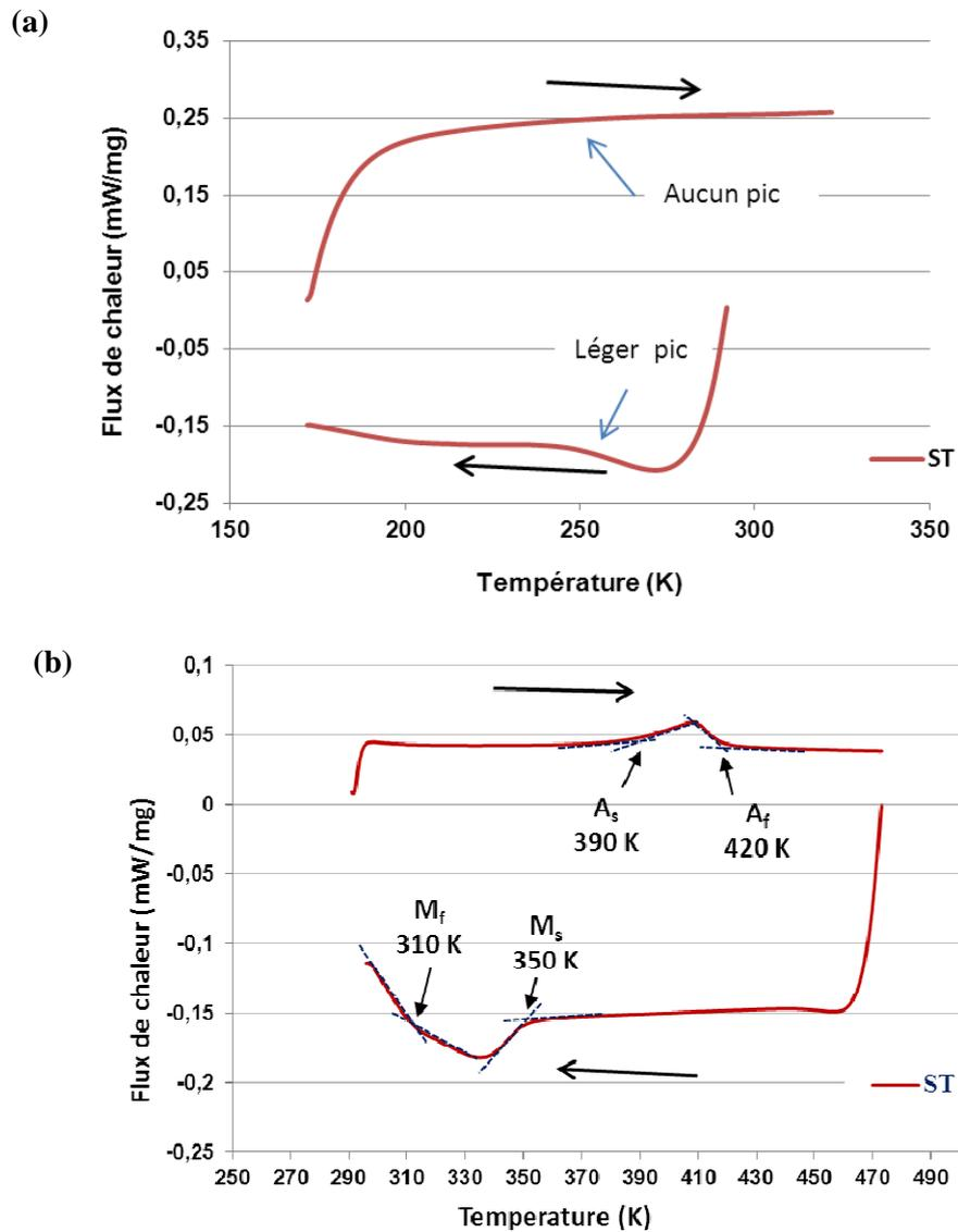
Figure III-21. Courbes DSC des deux alliages: (a) Ti-26Nb et (b) Ti-24Nb.
