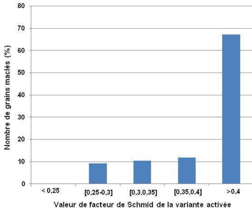
Figure IV-16. Valeur du facteur de Schmid de la variante observée dans les grains maclés.
