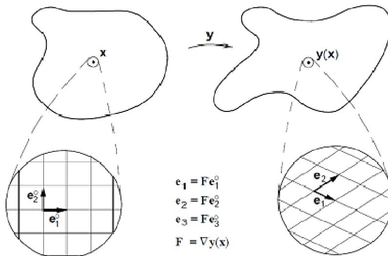
Figure A3-1. Illustration schématique de l'hypothèse de Cauchy-Born.
