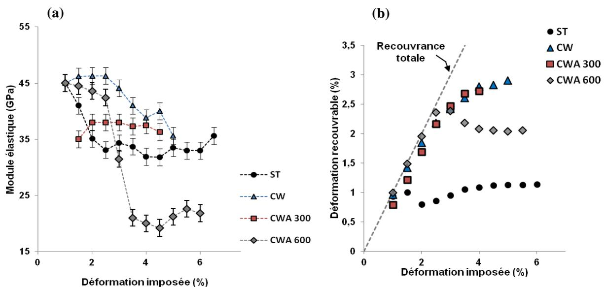
Figure V-13. Evolution des propriétés: (a) module apparent d'élasticité et (b) déformation recouvrable après chargement en traction de l'alliage Ti-26Nb pour les états ST, CW, CWA<sub>300</sub> et CWA<sub>600</sub>.
