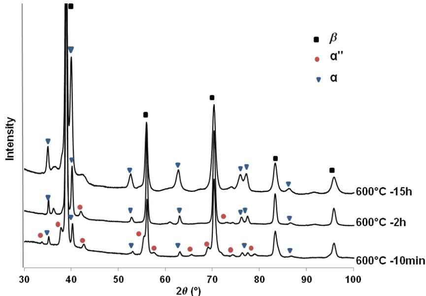
Figure V-15. Diffractogrammes réalisés après le traitement thermique à 600°C à différentes durées de maintien thermique : 10 min, 2h et 15h pour l'alliage Ti-24Nb.
