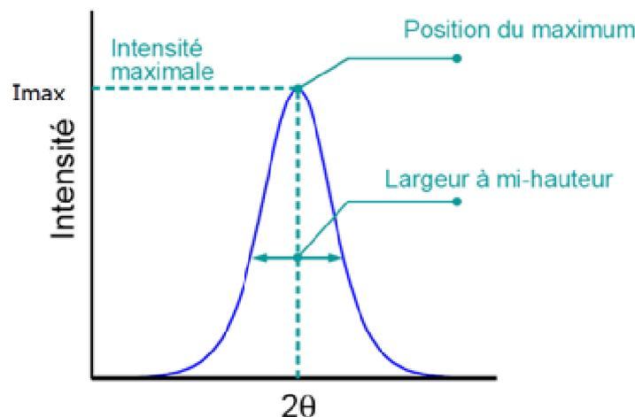
Figure III-18. Caractéristiques d'une raie de diffraction.
