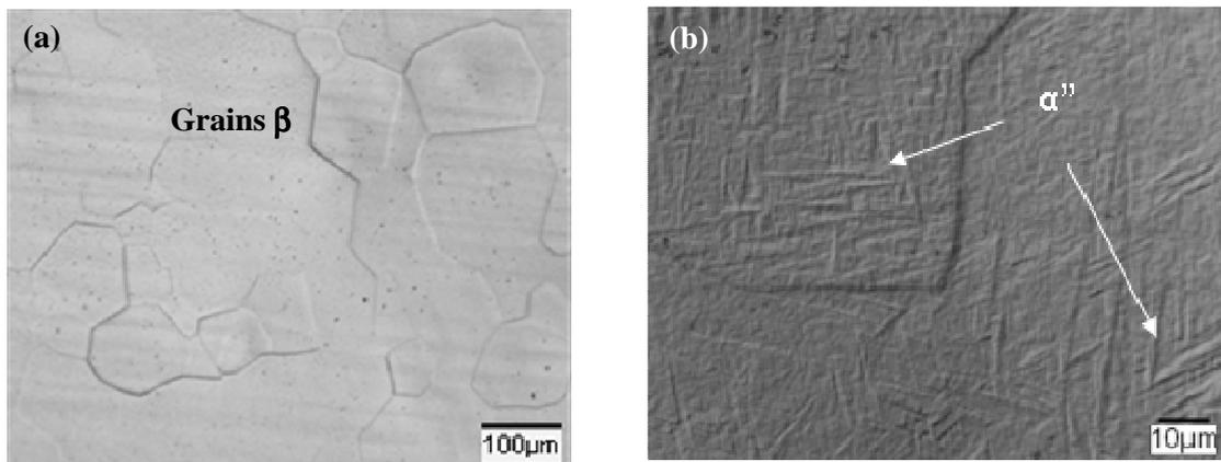
Figure III-15. Micrographies optiques obtenues après traitement de mise en solution : (a) Ti-26Nb, (b) Ti-24Nb
