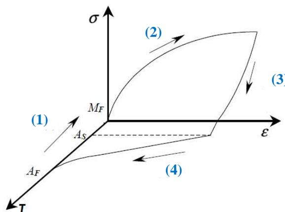
Figure I-14. Cycle thermomécanique et effet mémoire de forme.
