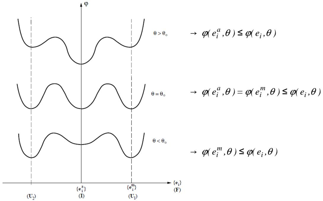
Figure VI-2. L'évolution de la densité d'énergie à différentes températures (Bhattacharya, 2003).
