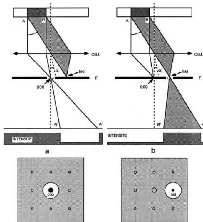
Figure II-9. (a) Image en champ clair formée avec le faisceau transmis, (b) Image champ sombre formée avec un faisceau diffracté (Ghanbaja, 2008).
