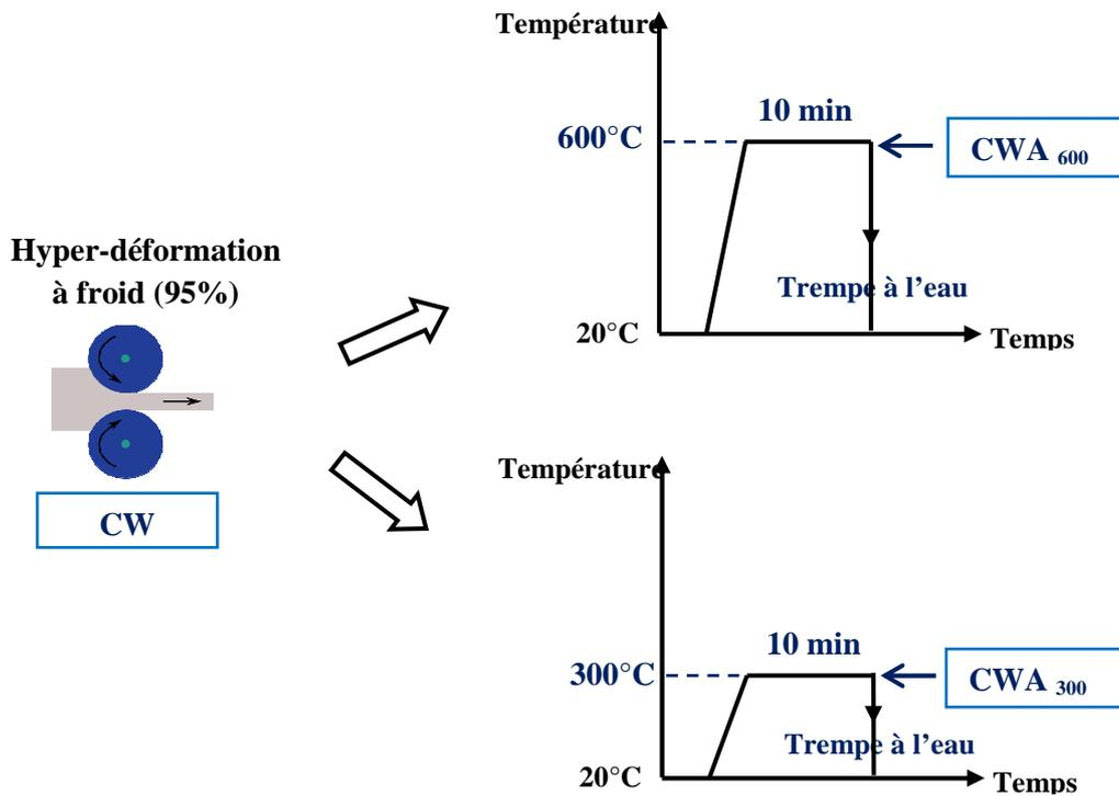
Figure V-1. Traitements thermo-mécaniques d'optimisation.
