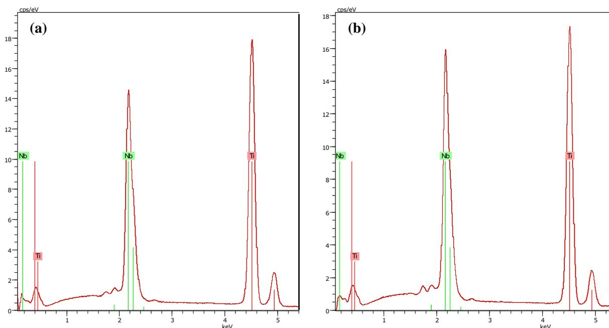
Figure III-13. Profils de concentration obtenus pour (a) Ti-24Nb et (b) Ti-26Nb après le traitement d'homogénéisation.
