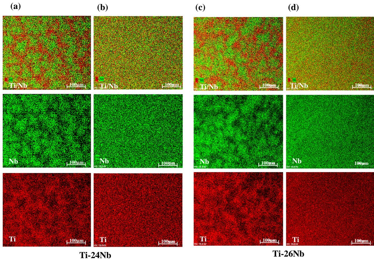
Figure III-12. Cartographies des éléments chimiques (a)-(c) avant le traitement d'homogénéisation et (b)-(d) après le traitement d'homogénéisation pour Ti-24Nb et Ti-26Nb.
