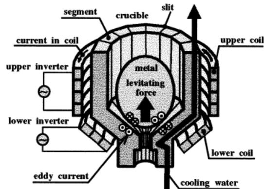
Figure II-2. Principe de la fusion en semi-lévitiation magnétique en creuset froid (Morita et al., 2000).
