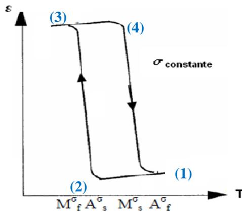
Figure I-13. Effet super-thermique à contrainte constante.
