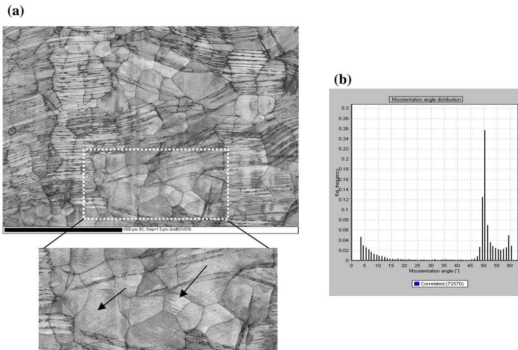
Figure IV-9. (a) Cartographie en contraste de bande BC pour l'alliage Ti-26Nb déformé à 10% en traction et (b) histogramme de désorientations correspondant.
