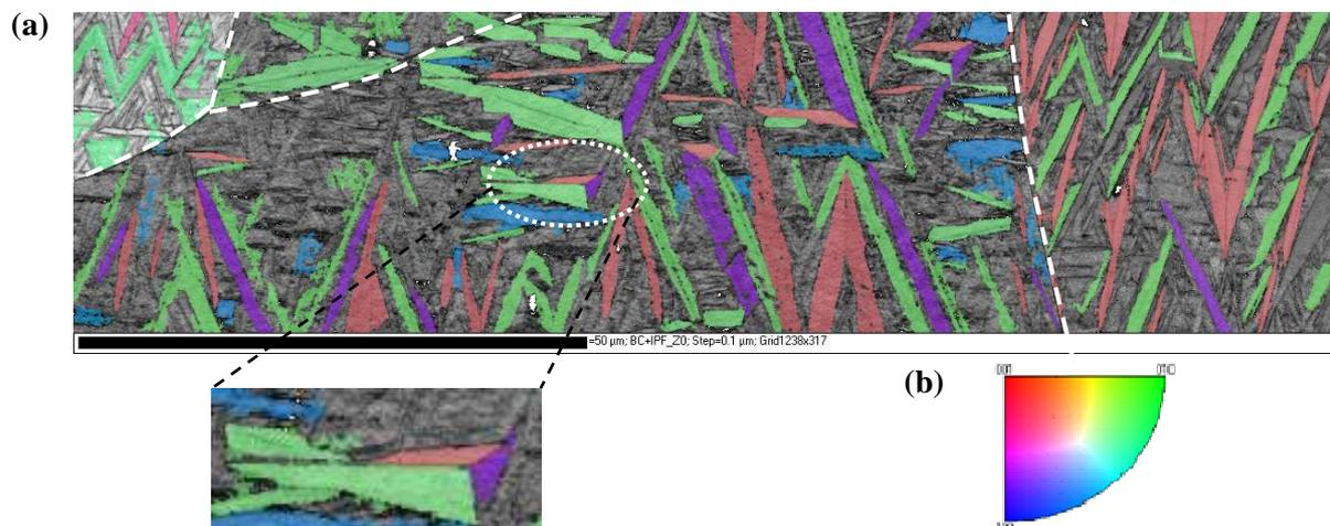
Figure IV-17. (a) Cartographie d'orientation en EBSD pour l'alliage Ti-24Nb à l'état ST et (b) code de couleur du triangle standard correspondant.
