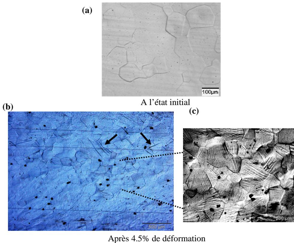
Figure IV-5. Evolution de la microstructure : (a) à l'état initial et (b) - (c) après 4,5% de déformation (Domaine III).
