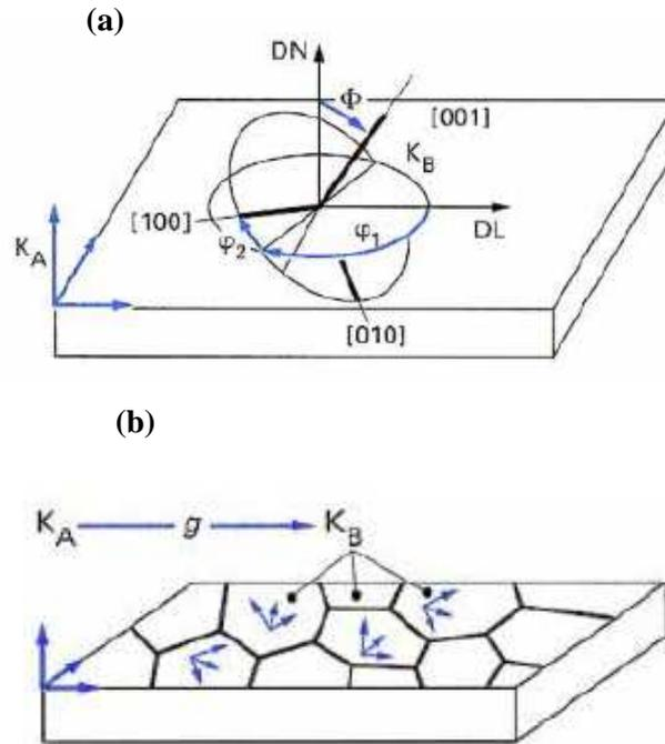
Figure IV-14. Orientation cristalline dans un matériau polycristallin; (a) par les angles d'Euler et (b) la rotation  $g$  reliant les deux systèmes de coordonnées (Esling and Bunge, 1997).
