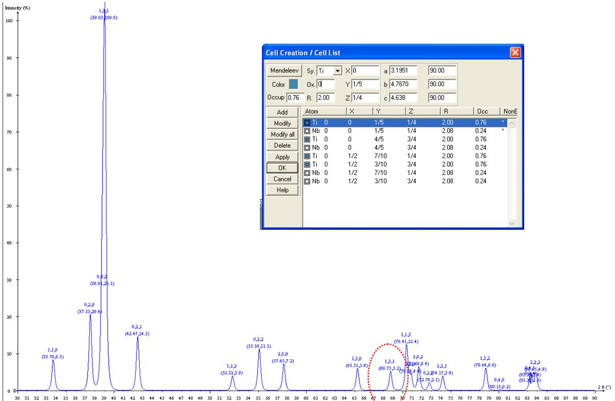
Figure III-19. Diffractogramme simulé de la phase martensitique: (a) avec  $y=1/6=0,166$  et (b)  $y=1/5=0,2$ .
