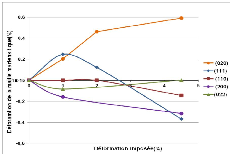
Figure IV-26. Déformation de la maille martensitique suivant différents plans en fonction de la déformation imposée durant l'essai de traction in-situ.
