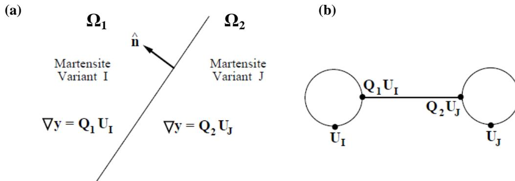
Figure A3-3. Représentation schématique de l'interface martensite/martensite.
