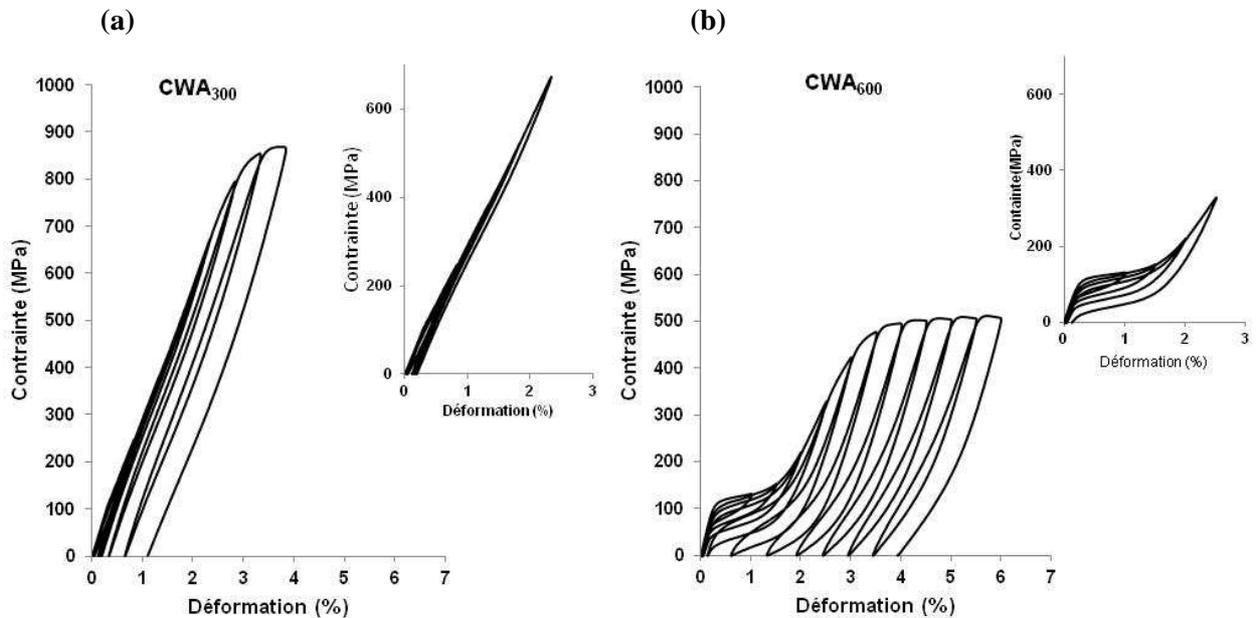
Figure V-3. Courbes de traction de l'alliage Ti-26Nb après traitements thermomécaniques à (a) 300°C-10min et (b) 600°C-10min. Les premiers cycles sont présentés dans des cartouches.
