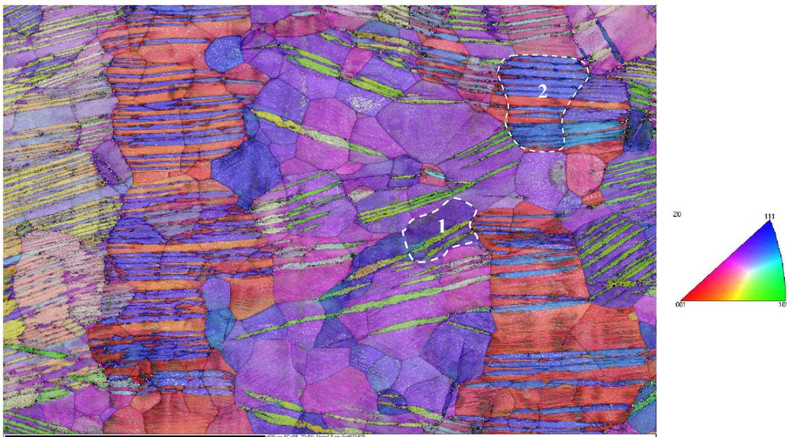
Figure IV-11. Cartographies d'orientations cristallographiques du Ti-26Nb après une déformation de 10% en traction.
