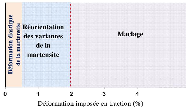
Figure IV-28. Diagramme mettant en évidence les mécanismes de déformation entrant en jeu en fonction de la déformation imposée dans le cas de traction uniaxiale pour l'alliage Ti-24Nb.
