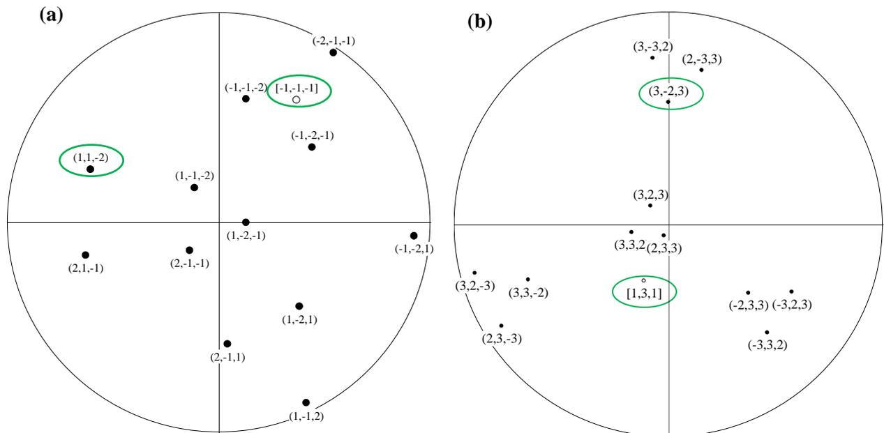
Figure IV-15. Figures de pôle simulé par Carine; (a) grain 1, (b) grain 2.
