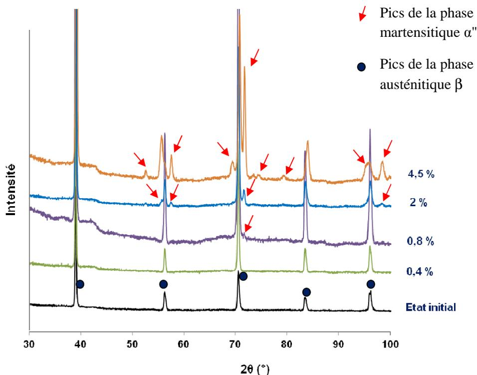
Figure IV-6. Les diffractogrammes intégrés à différents points de chargement.
