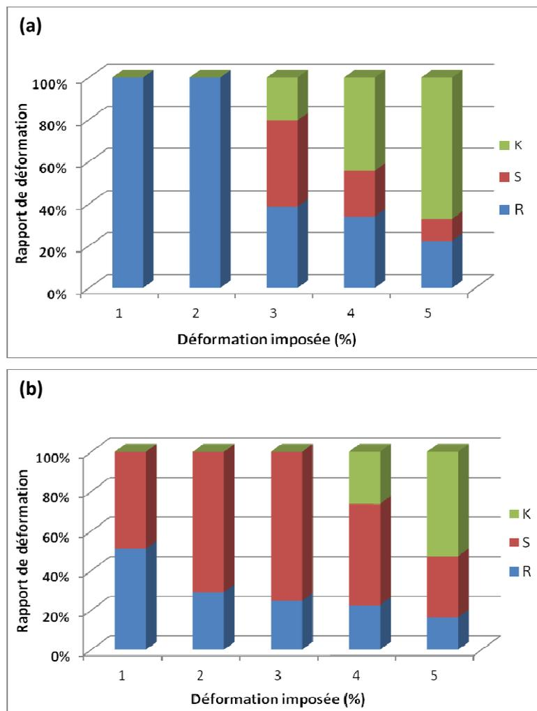
Figure III-27. Evolution des rapports d'intensité K, S et R pour (a) Ti-26Nb et (b) Ti-24Nb.
