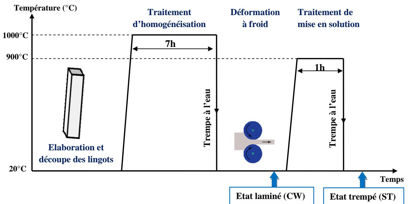
Figure III-11. Protocole thermomécanique appliqué aux lingots élaborés.
