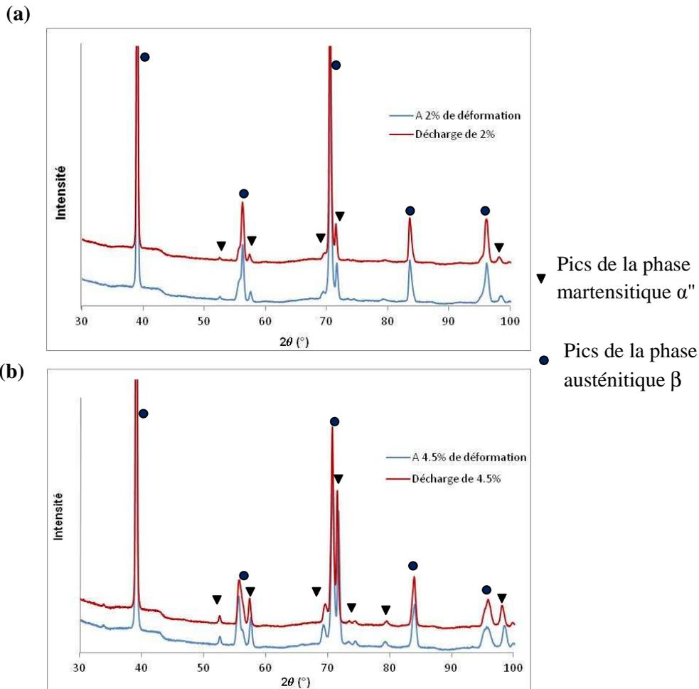
Figure IV-7. Stabilisation de la martensite après décharge: (a) après 2% de déformation et (b) après 4,5% de déformation.
