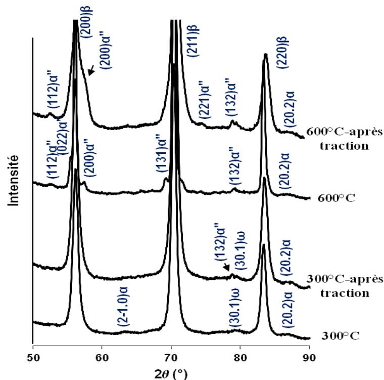
Figure V-11. Diffractogrammes réalisés à l'état  $CWA_{300}$  et  $CWA_{600}$  après rupture en traction pour l'alliage Ti-26Nb. Comparaison avec ceux réalisés avant déformation.
