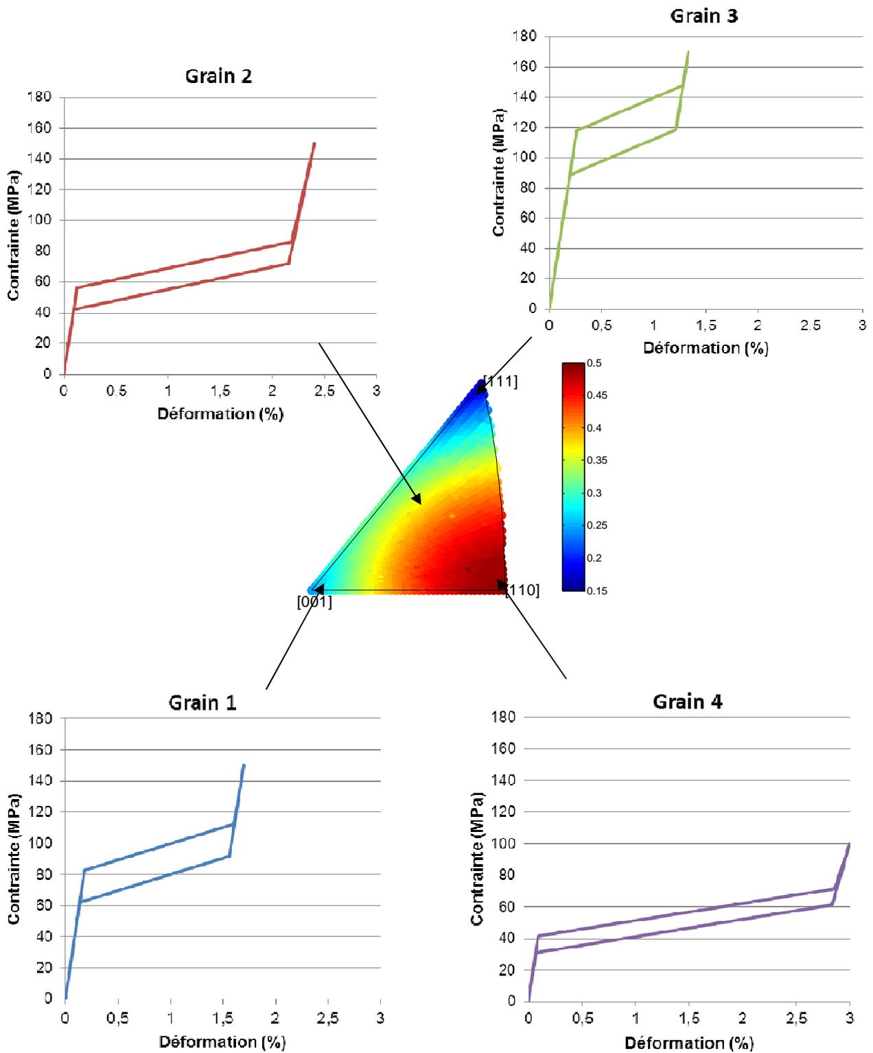
Figure VI-8. Comportement de quatre grains ayant des orientations cristallographiques différentes.
