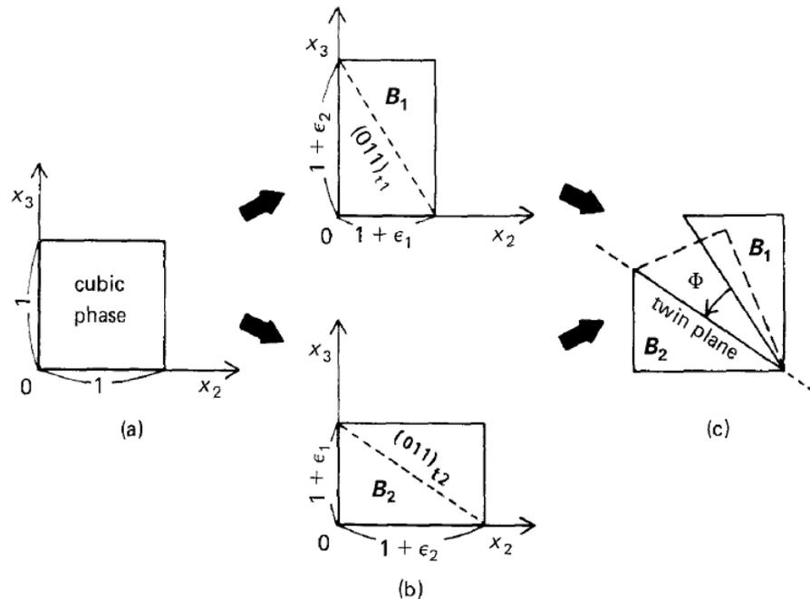
Figure VI-1. Illustration schématique de la transformation martensitique d'une structure cubique à une structure tétragonale en considérant une relation de maillage entre deux variantes de martensite.
