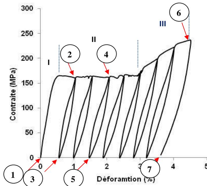
Figure IV-20. Courbe de traction avec des cycles charge-décharge du Ti-24Nb mettant en évidence les trois domaines de comportement (I, II et III) et les différents points de mesure.
