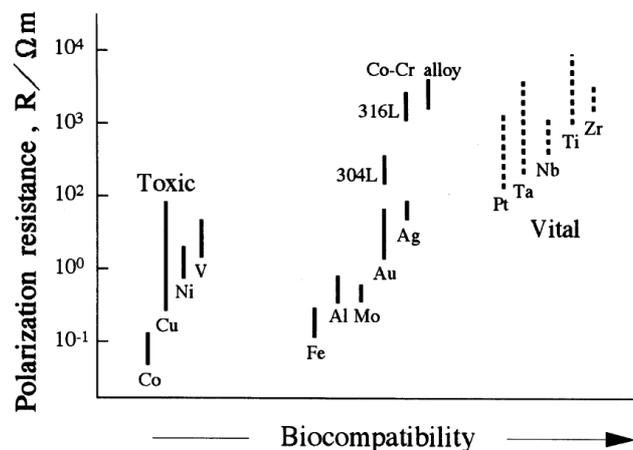
Figure I-16. Relation entre résistance de polarisation et biocompatibilité des métaux purs, alliage Co-Cr, acier inoxydable 316L et 304L (Steinemann, 1980).
