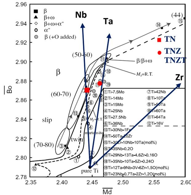
Figure III-7. Positionnement des trois alliages étudiés sur le diagramme  $\overline{Bo} - \overline{Md}$  et vecteurs illustrant l'effet des éléments d'addition Nb, Ta et Zr.
