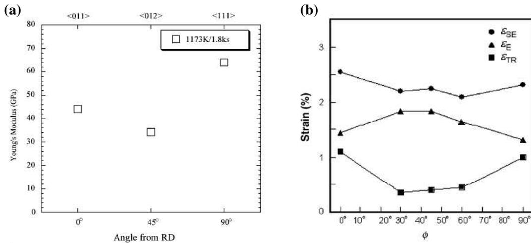
Figure I-23. (a) Variation des valeurs du module élastique en fonction de l'orientations pour un alliage Ti-22Nb-6Ta (at.%) (Kim *et al.*, 2006d) et (b) Evolution de la déformation recouvrable, élastique et de transformation suivant l'orientation  $\phi$  pour un alliage Ti-24Nb-3Al(at.%) (Inamura *et al.*, 2006).
