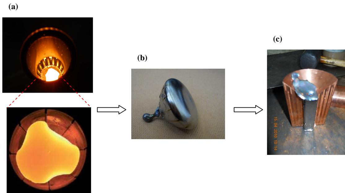
Figure II-3. (a) Bain de fusion en semi-lévitation, (b) lingot obtenu lors de l'étape intermédiaire après refroidissement dans le creuset et (c) lingot obtenu après la coulée dans la lingotière.
