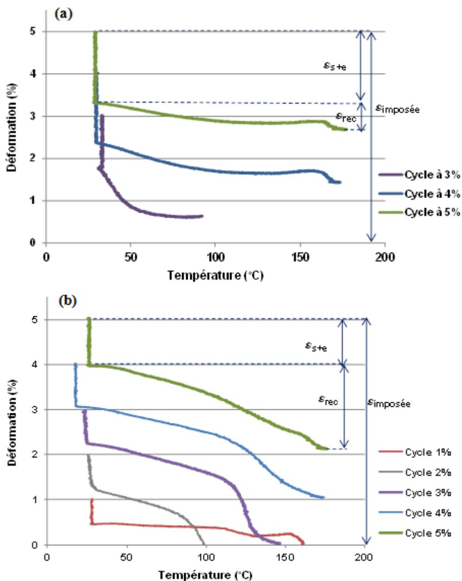
Figure III-26. Evolution de la déformation en fonction de la température au cours du chauffage pour (a) Ti-26Nb et (b) Ti-24Nb.
