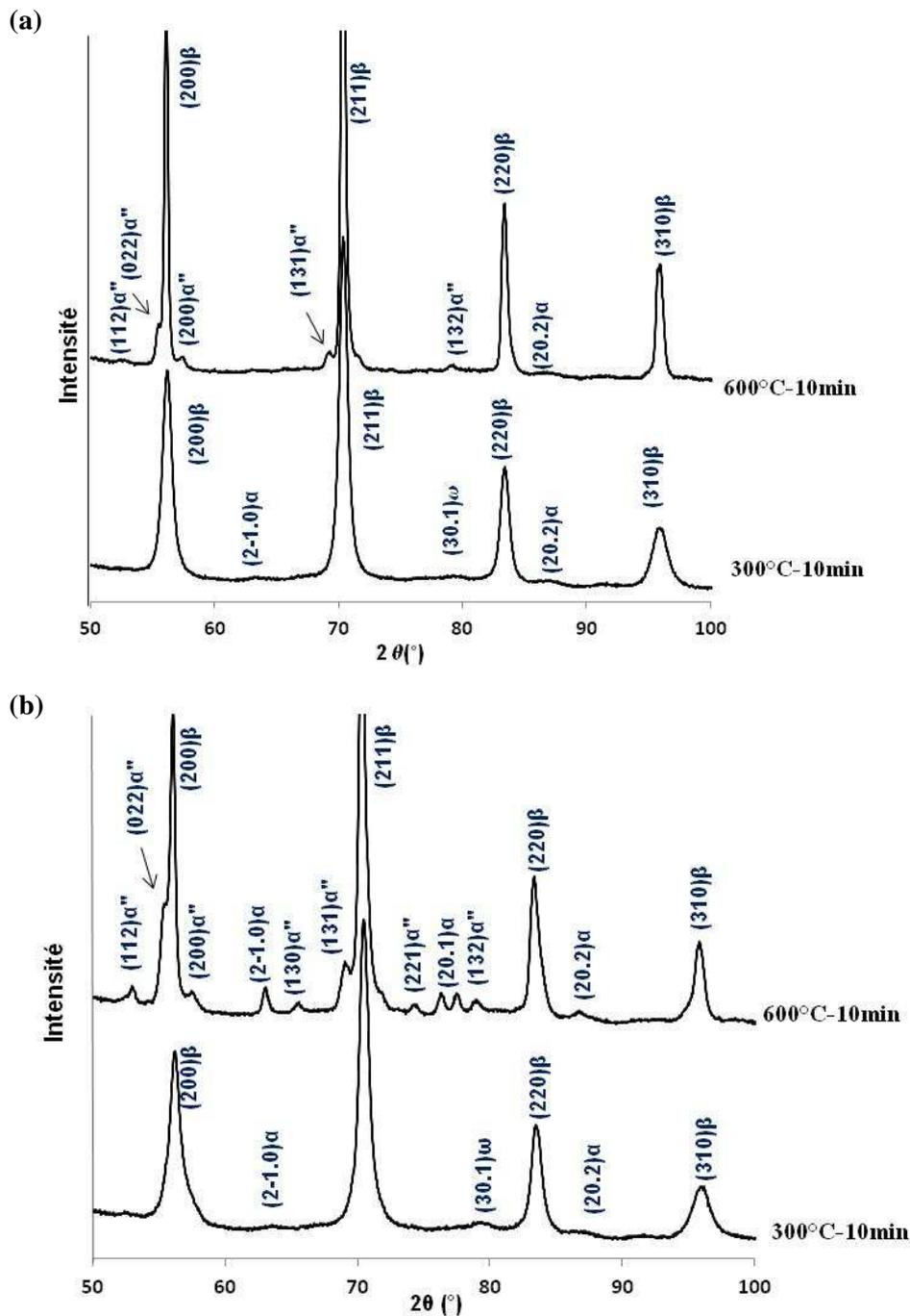
Figure V-5. Diffractogrammes obtenus après les traitements thermomécaniques "flash" pour les deux alliages : (a) Ti-26Nb et (b) Ti-24Nb.
