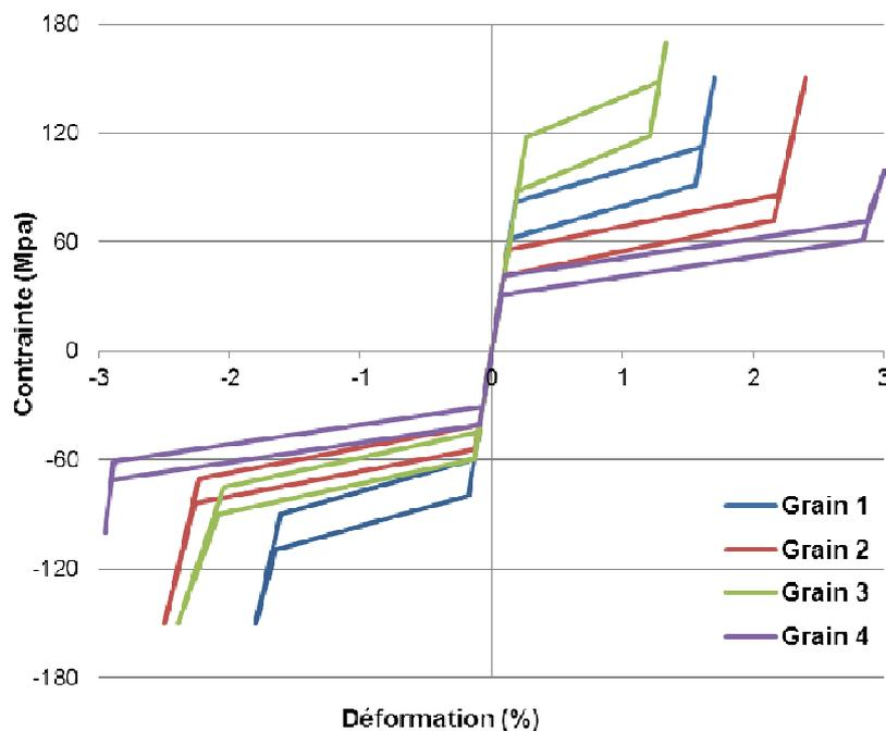
Figure VI-9. Courbes de comportement des quatre grains en traction - compression.
