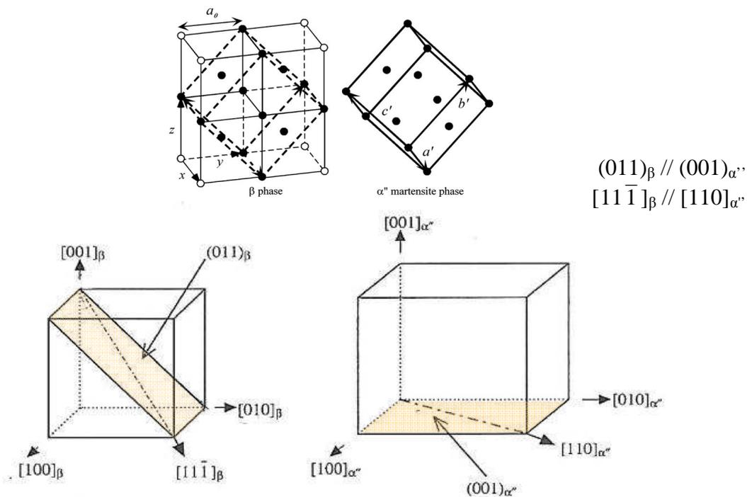
Figure I-4. Représentation schématique de la relation d'orientation entre le réseau cubique centré de la phase  $\beta$  et le réseau orthorhombique de la phase martensitique  $\alpha''$  (Pionnier, 1997).
