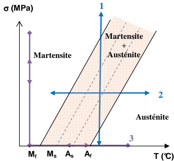
Figure I-11. Différents trajets de chargement schématisés sur un diagramme d'état de la transformation Austénite-Martensite.
