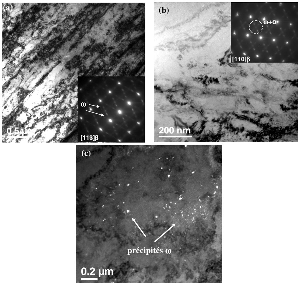
Figure V-10. Images MET de l'alliage Ti-26Nb après un traitement thermique à 300°C pendant 10 min: (a) image en champ clair mettant en évidence le sens du laminage, (b) image en champ clair et le cliché de diffraction selon l'axe de zone  $[110]_{\beta}$  et (c) image en champ sombre montrant les précipités nanométriques de la phase  $\omega$ .
