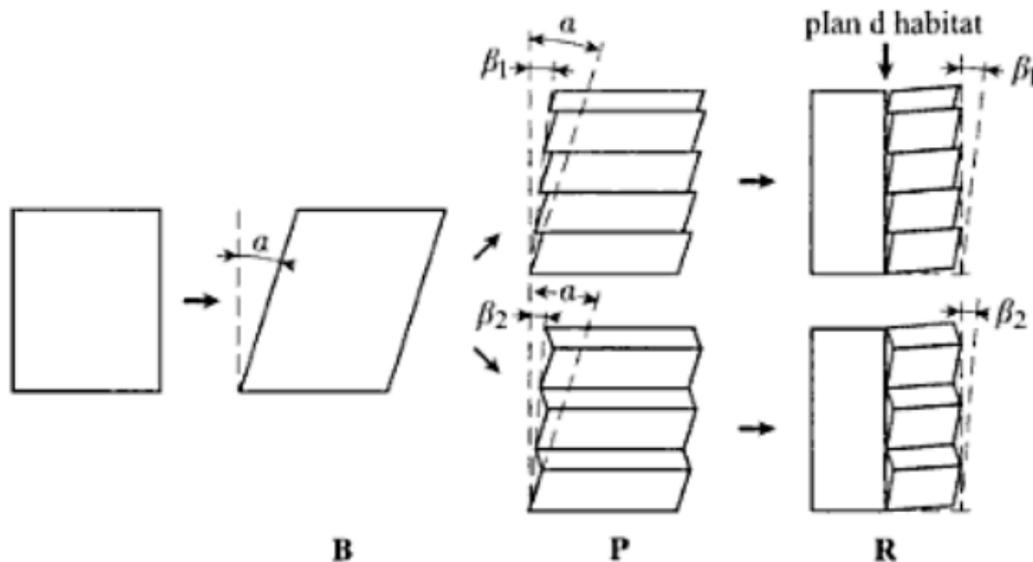
Figure A2-2. Les trois opérations permettant de passer de la maille austénitique à la maille martensitique (*Janot and Ilchner, 2001*).
