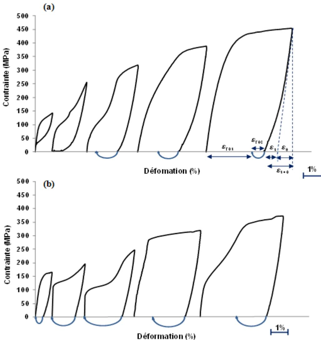
Figure III-25. Courbes de traction obtenues pour (a) Ti-26Nb et (b) Ti-24Nb.
