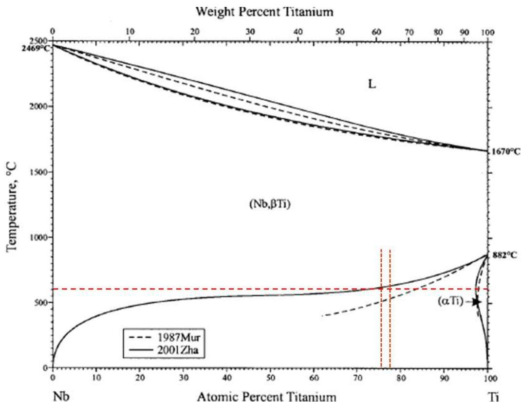
Figure V-6. Diagramme d'équilibre des alliages binaires (Okamoto, 2002)
