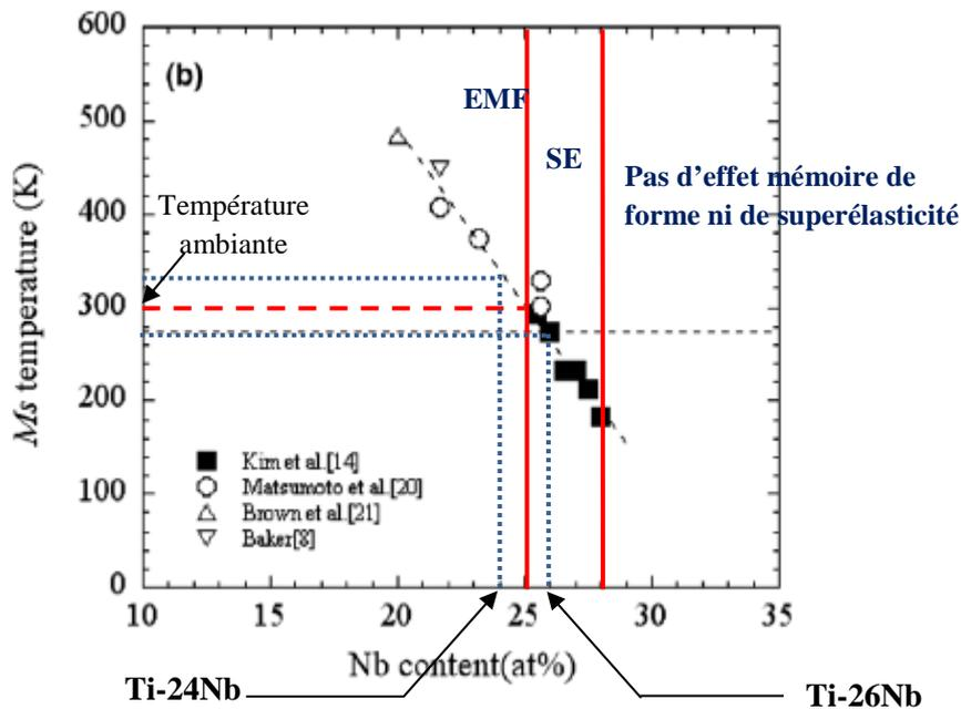
Figure III-10. Influence de l'ajout du Nb sur la température  $M_s$  (Kim et al. 2006b).
