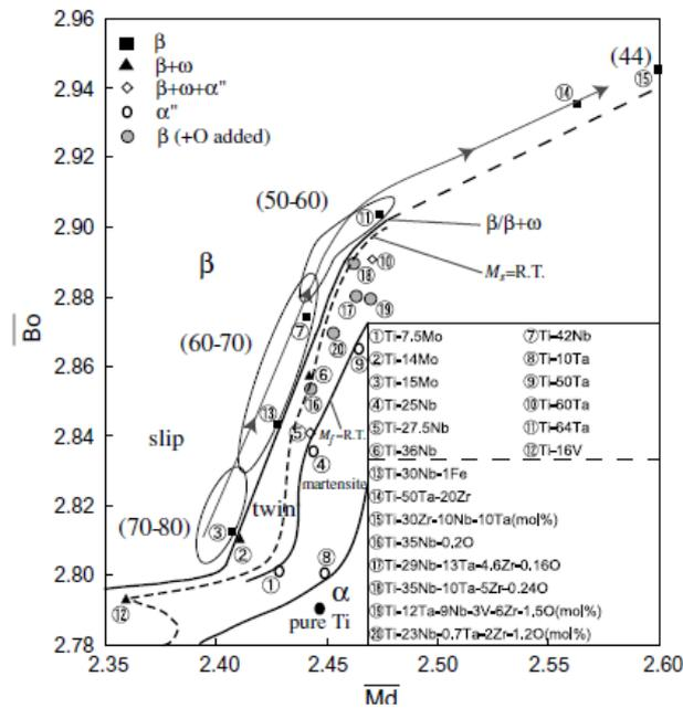
Figure III-2. Diagramme  $\overline{Bo} - \overline{Md}$  étendu indiquant les microstructures de trempe et les mécanismes de déformation ainsi que les valeurs du module  $E$  en GPa entre parenthèses (Abdel-Hady et al. 2006).
