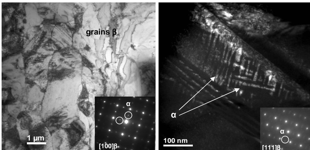
Figure V-16. Images MET de l'alliage Ti-24Nb après un traitement thermique à 600°C pendant 2h: (a) image en champ clair mettant en évidence les grains  $\beta$  et (b) image en champ sombre montrant les précipités nanométriques de la phase  $\alpha$  et le cliché de diffraction selon l'axe de zone  $[111]_{\beta}$ .
