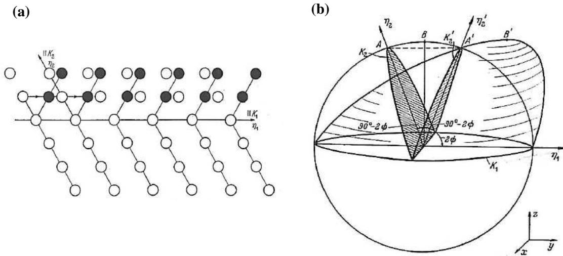
Figure I-6. (a) Schéma d'une macelle, (b) Relations géométriques intervenant dans le maillage (Hall, 1954).
