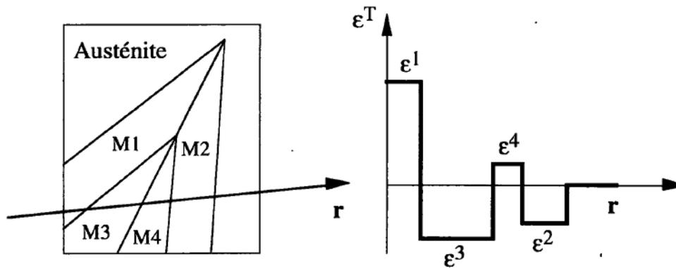
Figure A4-1. Représentation schématique d'une déformation uniforme par morceaux dans la martensite.
