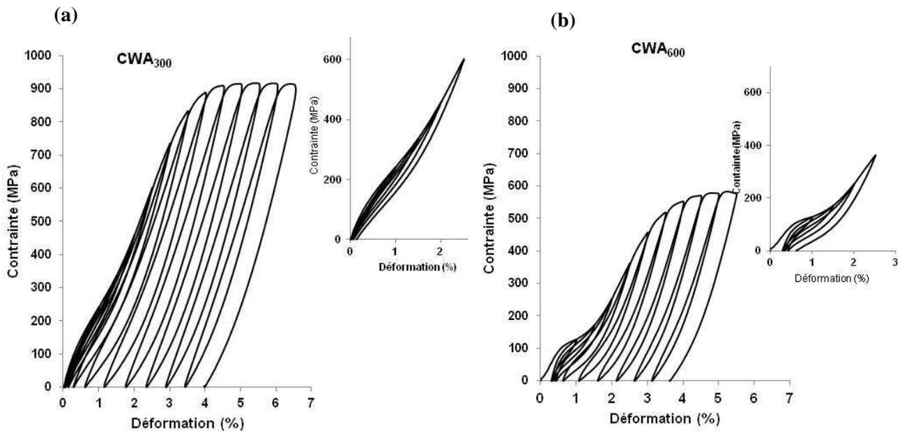
Figure V-4. Courbes de traction de l'alliage Ti-24Nb après traitements thermomécaniques à (a) 300°C-10min et (b) 600°C-10min. Les premiers cycles sont présentés dans des cartouches.
