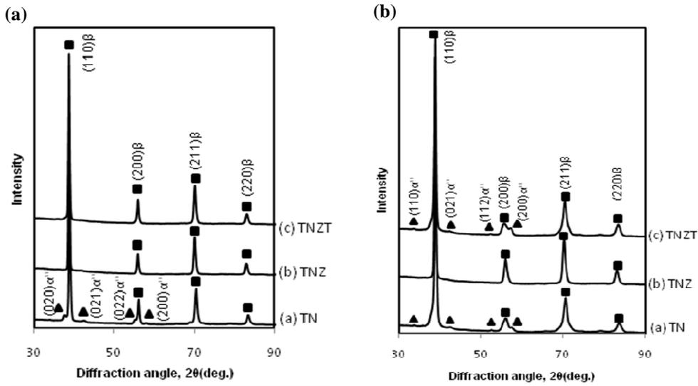
Figure III-8. DRX obtenus pour les alliages TN, TNZ, TNZT à (a) l'état trempé et (b) après la déformation en traction.
