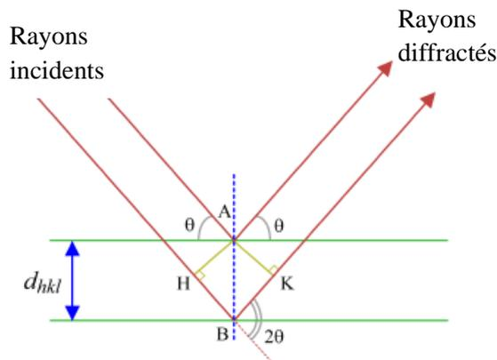
Figure II-5. Schéma du principe de la diffraction des rayons X illustrant la loi de Bragg.
