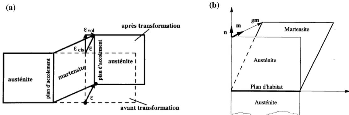
Figure I-9. (a) Formation d'une plaquette de martensite accompagnée d'un cisaillement  $\epsilon_{cis}$  et d'une déformation responsable du changement de volume  $\epsilon_{vol}$  et (b) caractéristiques cristallographiques associées à la formation d'une variante de martensite.
