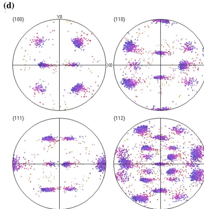
Figure IV-1. (a) Cartographie d'orientation en EBSD, (b) code de couleur du triangle standard, (c) Histogramme de désorientation correspondant et (d) figures de pôle des plans  $\{100\}_\beta$ ,  $\{110\}_\beta$ ,  $\{111\}_\beta$  et  $\{112\}_\beta$  pour l'alliage Ti-26Nb.
