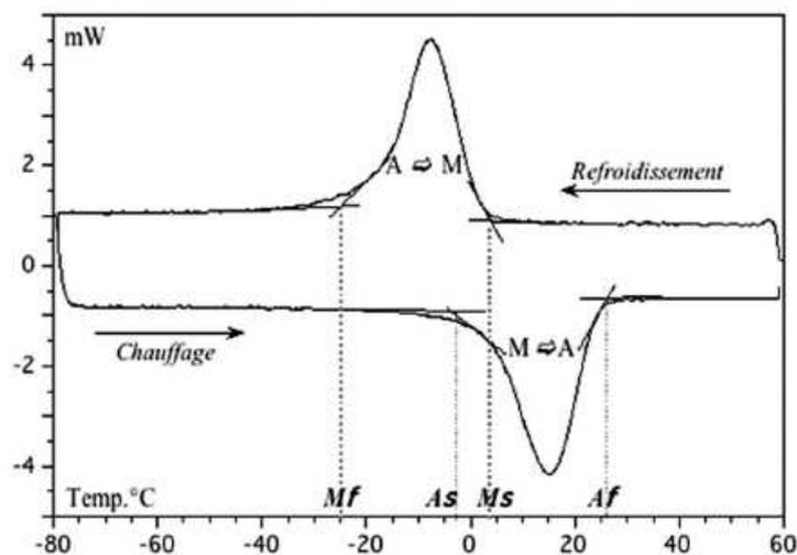
Figure II-10. Courbes DSC d'un arc orthodontique NiTi présentant les pics caractéristiques de la transformation martensitique (A: Austénite ; M: Martensite) (Jordan and Rocher, 2009).
