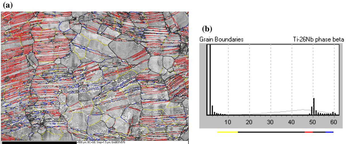
Figure IV-10. (a) Cartographie de désorientation angulaire et (b) distribution de désorientation angulaire.
