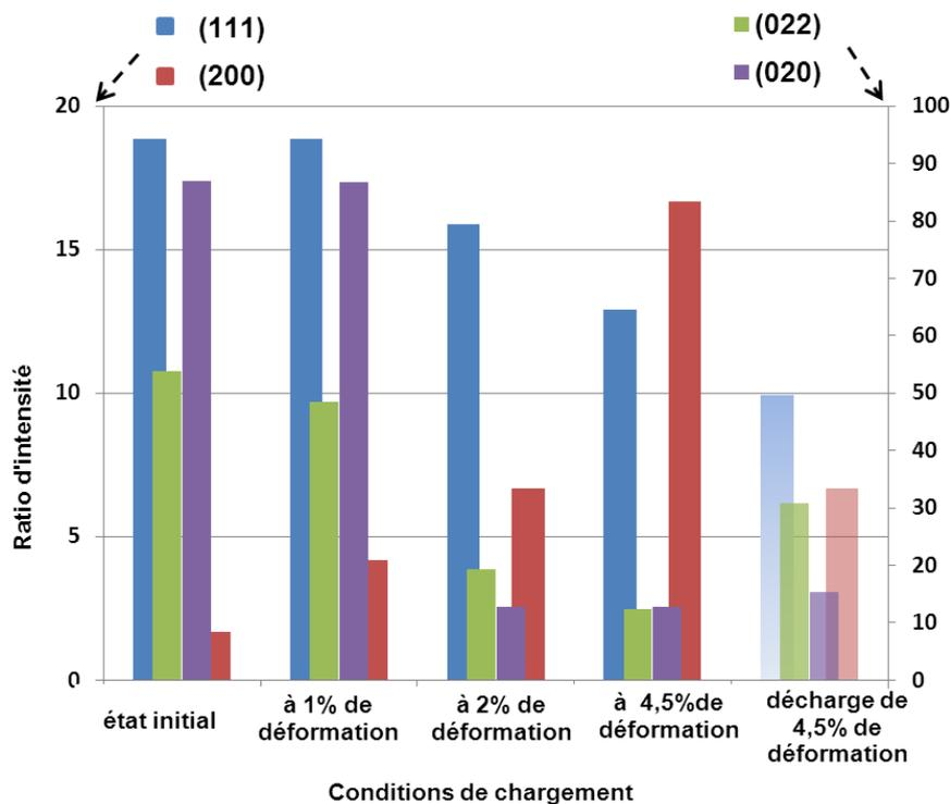
Figure IV-23. Evolution des intensités des figures de pôle  $(020)_{\alpha'}$ ,  $(111)_{\alpha'}$ ,  $(022)_{\alpha'}$  et  $(200)_{\alpha'}$  en fonction des différentes conditions de chargement.
