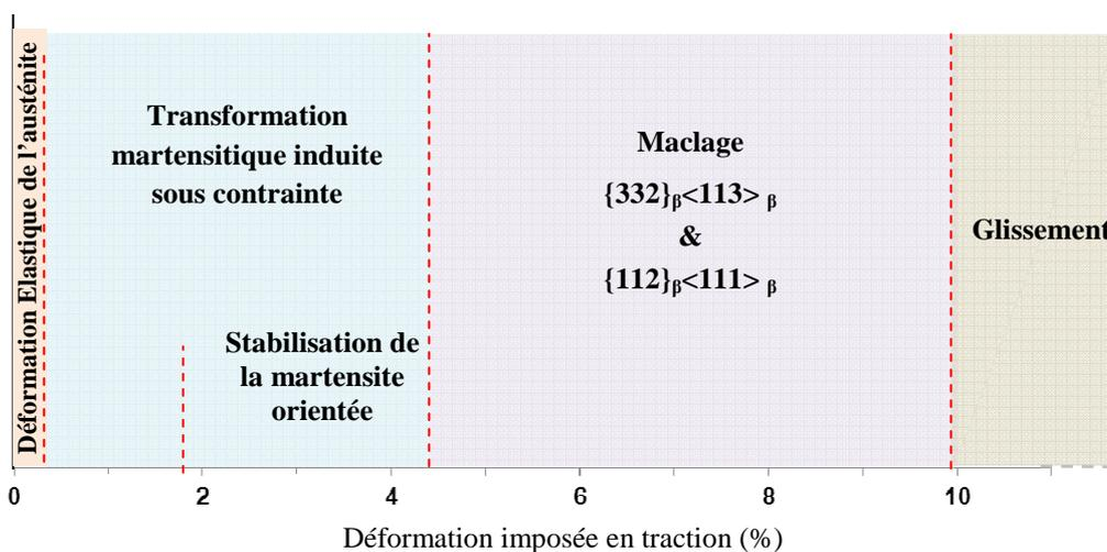
Figure IV-27. Diagramme mettant en évidence les mécanismes de déformation entrant en jeu en fonction de la déformation imposée dans le cas de traction uniaxiale pour l'alliage Ti-26Nb.
