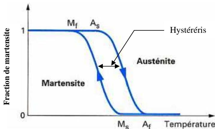
Figure I-10. Fraction de la martensite transformée en fonction de la température.
