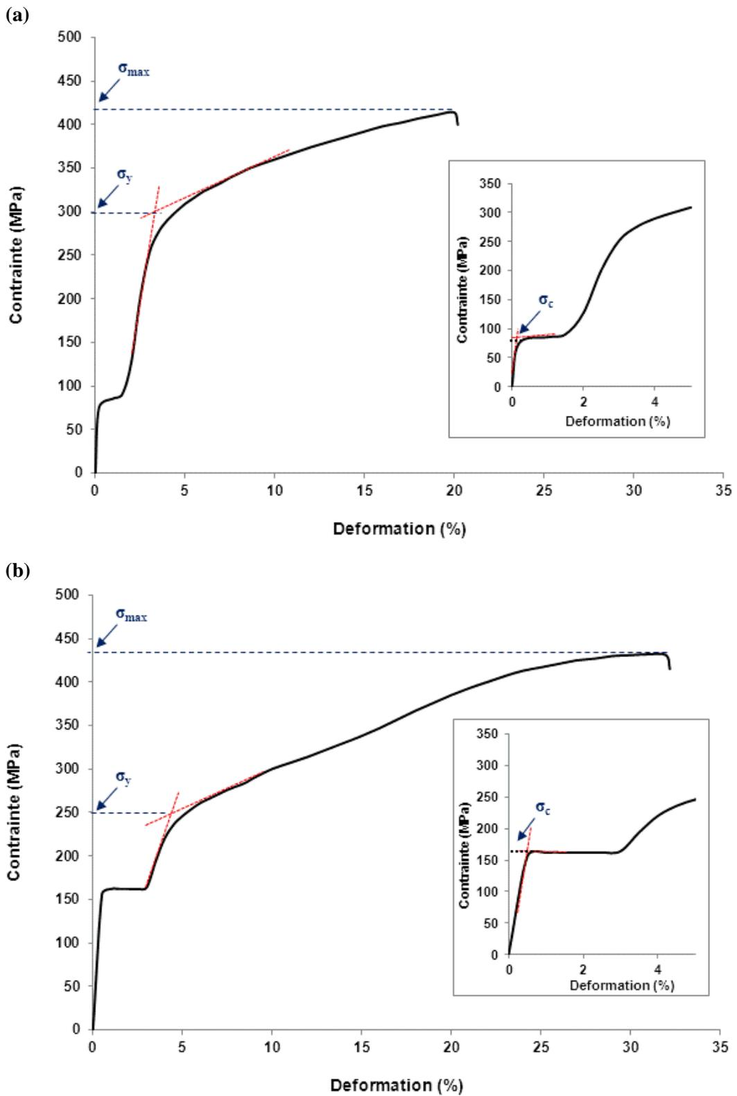
Figure III-24. Courbes de traction des deux alliages: (a) Ti-26Nb et (b) Ti-24Nb.
