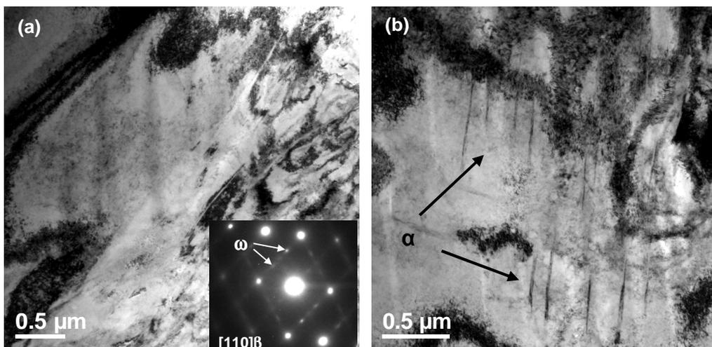
Figure V-8. Images MET de l'alliage Ti-24Nb après un traitement thermique à 300°C pendant 10 min: (a) image en champ clair montrant la microstructure obtenue et le cliché de diffraction correspondant et (b) image en champ clair montrant des plaquettes de la phase  $\alpha$ .
