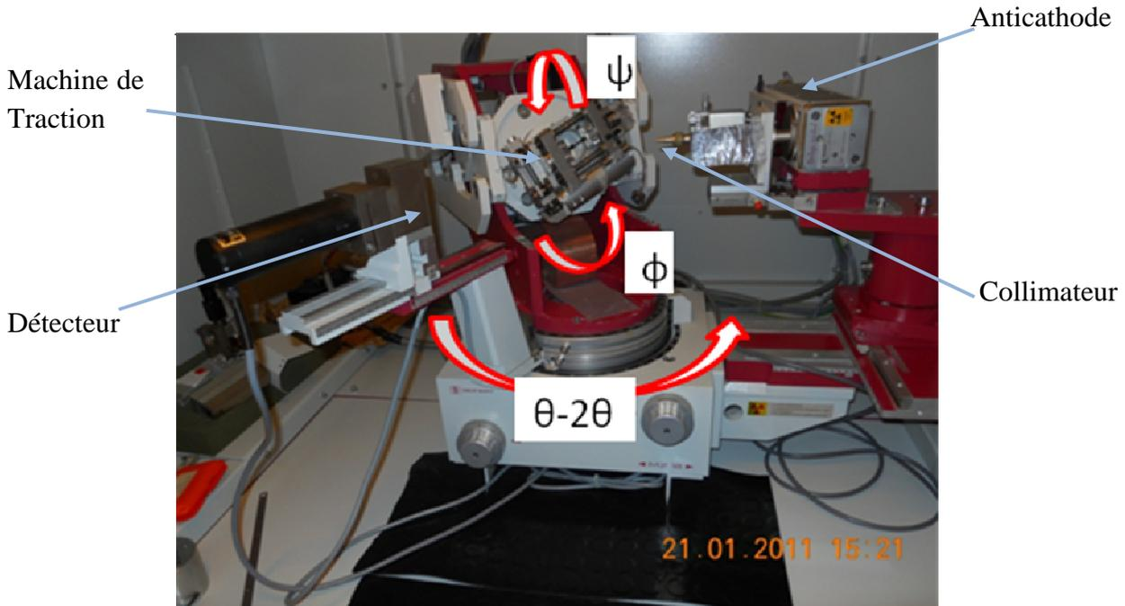
Figure IV-19. (a) Diffractomètre Seifert XRD 3003PTS.
