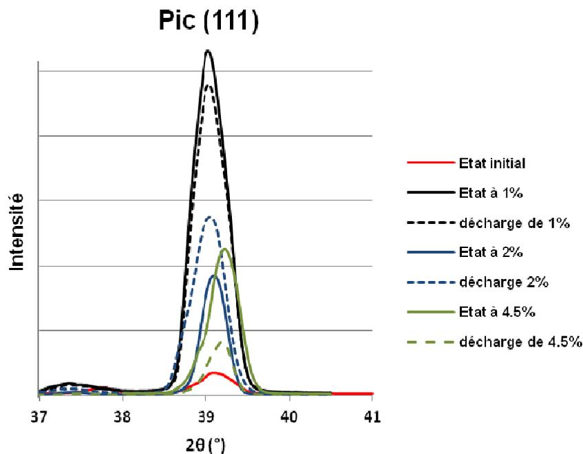
Figure IV-24. Décalage angulaire du pic (111) au cours du cyclage.
