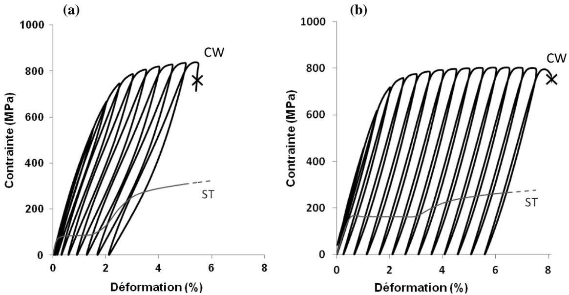
Figure V-2. Courbes de traction après déformation à froid (CW): (a) Ti-26Nb et (b) Ti-24Nb. Comparaison avec les réponses obtenues à l'état ST.
