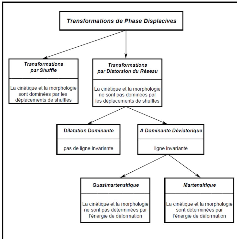
Figure I-8. La classification des transformations de phase par cisaillement et sans diffusion (*Cohen et al., 1979*).
