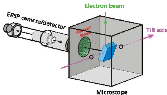
Figure II-8. Représentation schématique de la position de l'échantillon pour des mesures en EBSD.
