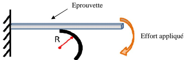
Figure A1-1. Schéma du dispositif utilisé pour les essais de fatigue.
