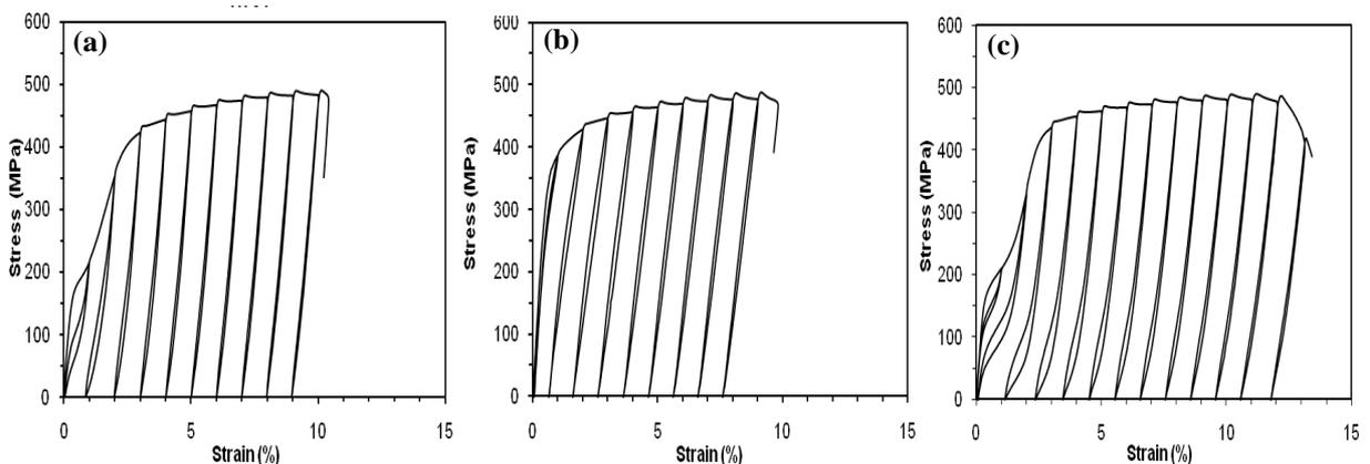
Figure III-9. Comportement mécanique obtenu à l'état trempé pour les trois alliages après une mise en solution : (a) TN, (b) TNZ et (c) TNZT.
