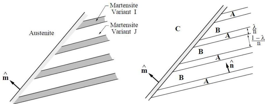
Figure VI-4. Représentation schématique de la configuration étudiée (Bhattacharya, 2003).
