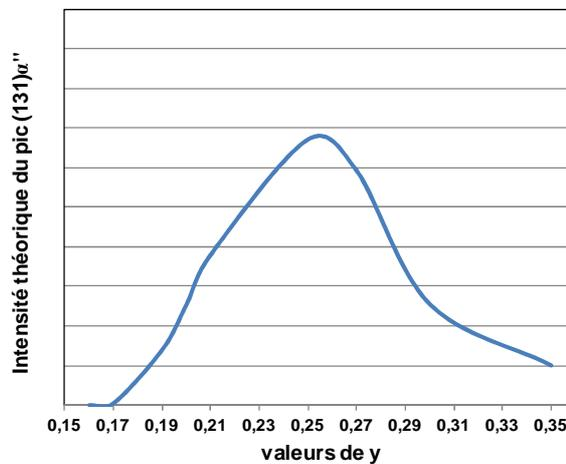
Figure III-20. Variation de l'intensité du pic  $(131)_{\alpha}$  en fonction de la position  $y$ .
