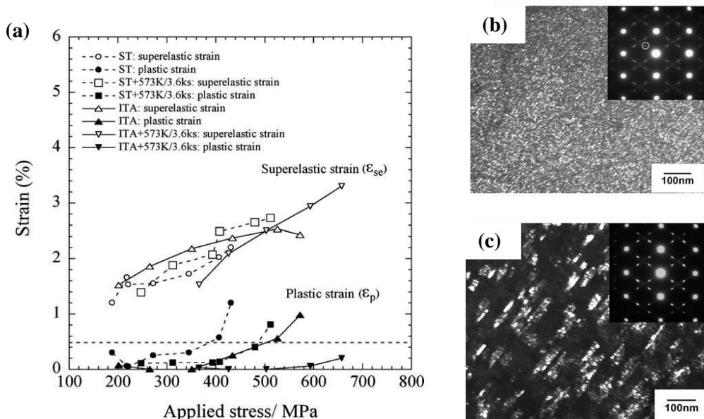
Figure I-22. (a) La déformation superélastique et plastique en fonction de la contrainte appliquée sur l'alliage Ti-26Nb ayant subi différents traitements thermomécaniques, Images en champ sombre après un traitement à (b) 300°C-3,6ks et (c) 300°C-36ks (Kim et al., 2006b).
