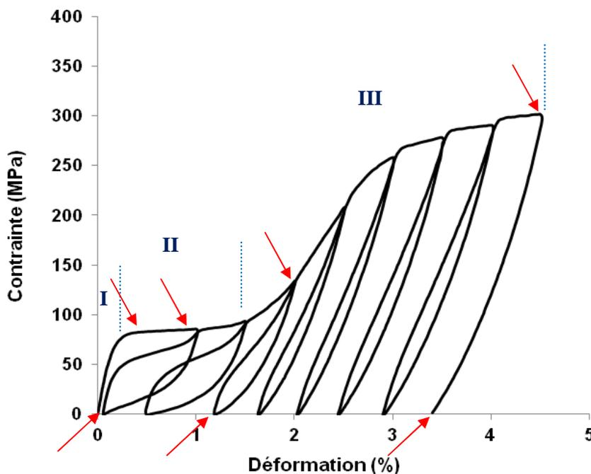
Figure IV-4. Courbe de traction du Ti-26Nb avec un chargement cyclique mettant en évidence les trois domaines de comportement (I, II et III) et les différents points de mesure.
