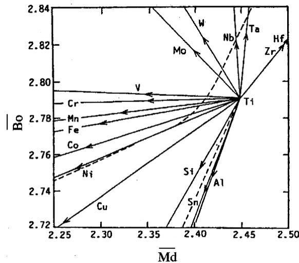
Figure III-1. Evolution des valeurs  $\overline{Bo}$  -  $\overline{Md}$  pour différents alliages binaires (Kuroda et al., 1998).
