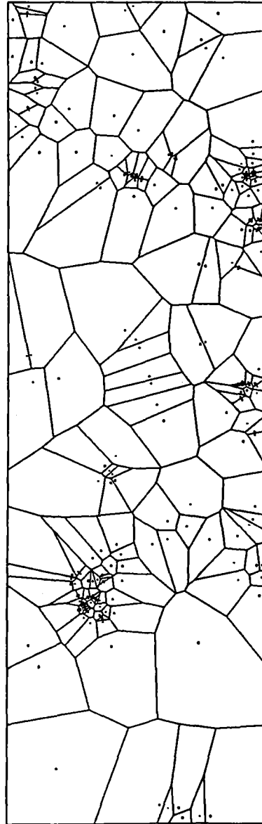
Figure (A3.8): (a) Cellules de Voronoi de l'échantillon N° 2G2 ( \epsilon^P = 15,8 \% ). (b) Triangulation de Delaunay correspondante.
