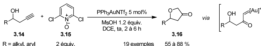
Figure 3-14 : Synthèse de furan-3-one par catalyse oxydante à l'or(I)
