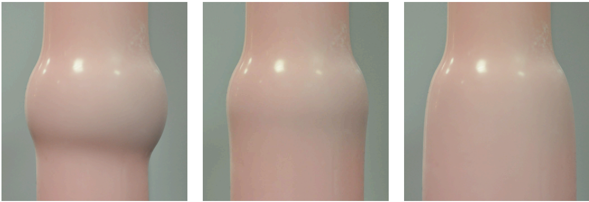
FIGURE 4.27 – Série temporelle de prises de vues d’une expérience à débit entrant constant. La sphère d’acier de masse m = 600 g et de rayon R = 25 mm est fixe. Le cylindre de PolyVinylSiloxane (PVS) shore 8 ( E = 0,24 MPa) a pour rayon R_0 = 18 mm et pour épaisseur h = 2 mm. La pression augmente en dessous de la sphère, gonflant le cylindre, jusqu’à ce que le rayon de la partie inférieure atteigne une taille critique supérieure à R + h , permettant à l’air de s’échapper autour de la sphère.
