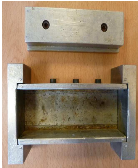
Figure 2 - 9. Moule pour panneaux de process 150 x 50 mm 2
