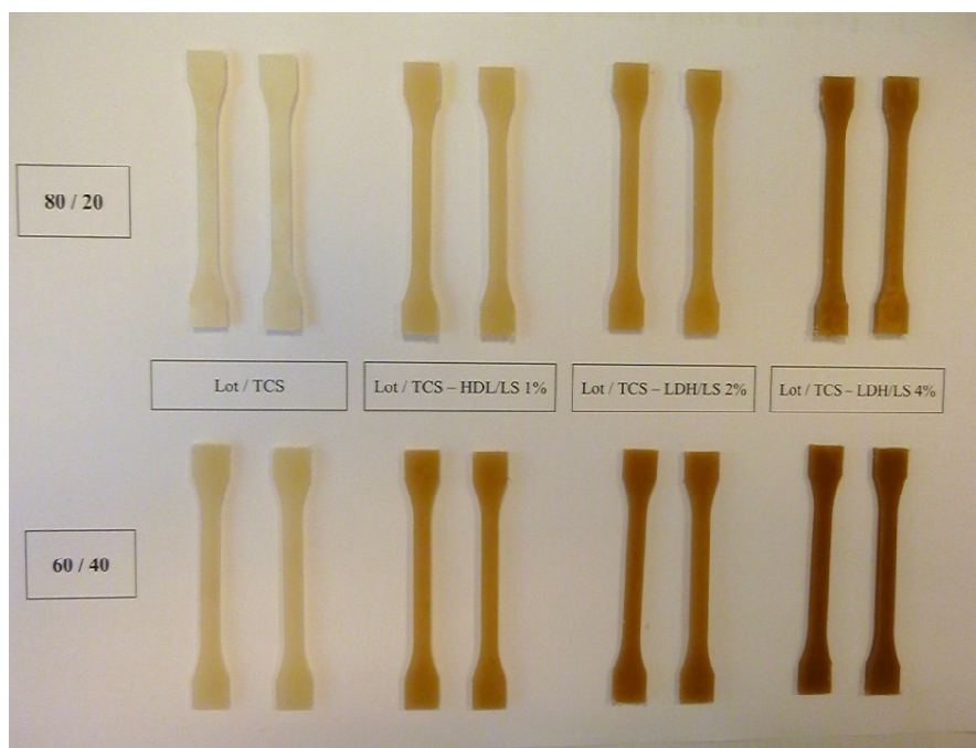
Figure 5 - 10. Eprouvettes des différentes formulations Lotader / (amidon – HDL/LS).
