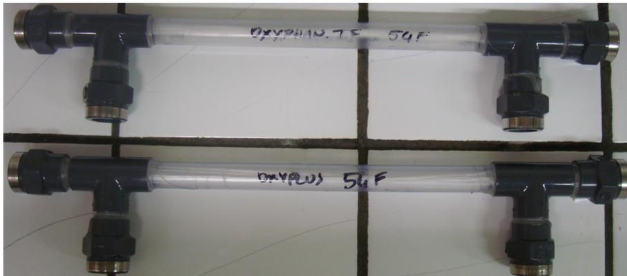
FIGURE 3.1 – Contacteurs membranaires avec deux types de fibres
