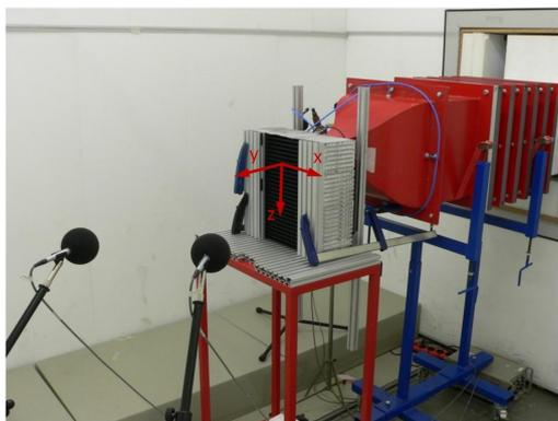
**Figure 2.12:** Montage d'un échangeur à la sortie du jet d'air dans la chambre semi-anéchoïque de l'Université de Siegen. Figure extraite d'un rapport d'essai effectué à l'Université de Siegen dans le cadre d'Ecoquest
