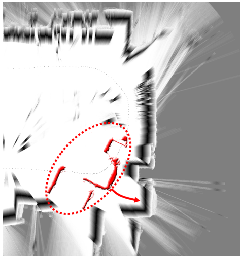
FIGURE 3.5 – L'algorithme de scan-matching essaie de trouver la bonne combinaison translation/rotation entre les données d'un scan du laser et la carte établie
