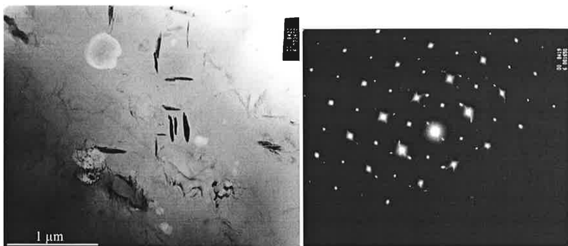
Figure III.14 : précipitation d'aiguilles de type Ni_3 (Ti, Ta, Al), de chrome métallique et de phase TCP dans un grain de \beta - NiAl de la sous-couche externe, échantillon à substrat bas soufre oxydé 50h à 1100°C, image MET et cliché de diffraction correspondant (coupe \langle 001 \rangle ).
