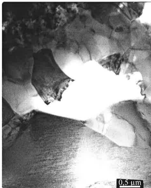
Figure IV.16 : observation d'un pore localisé à l'interface oxyde / métal, éprouvette bas soufre testée en fatigue anisotherme, cycle BTBA, lame mince en section transverse observée en microscopie en transmission.
