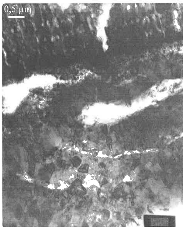
Figure IV.18 : vue en coupe d'une zone avec des multi-couches d'alumine, éprouvette bas soufre testée en fatigue anisotherme, ( \Delta \epsilon \text{ mec} = 0,56 \% ), temps équivalent à 1100^\circ\text{C} = 32\text{h} , lame mince en section transverse observée en microscopie en transmission.
