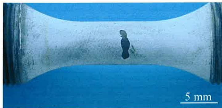
Figure V.3 : éprouvette 84E1 (AM1 bas soufre, pas de pré-oxydation, cylindre Ø 6), écaillage localisé dans la zone centrale, faciès de type 2
