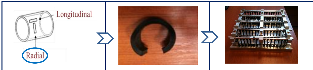
Figure 14. Prélèvement des éprouvettes d'élastomère industriel et mise en place pour les essais de vieillissement thermique en étuve ventilée.
