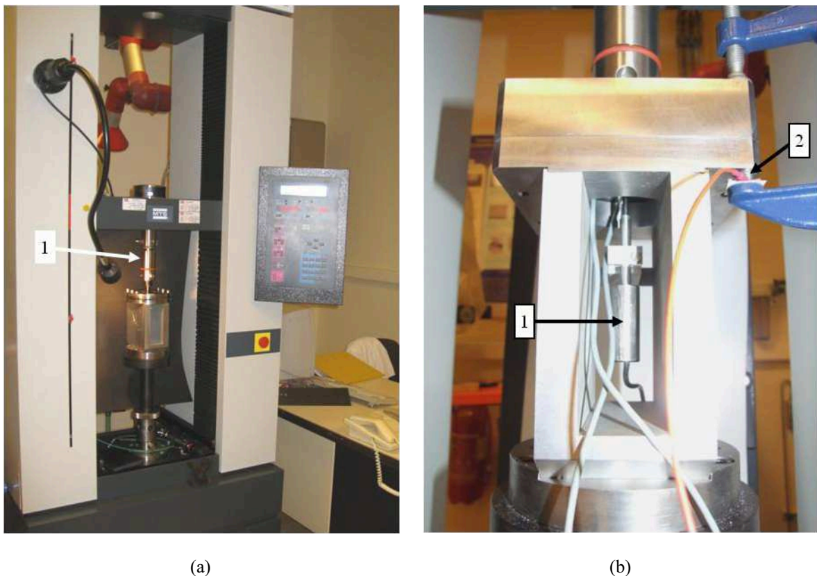
Figure 2.2. Dispositif d'indentation hors-plan et instrumentation supplémentaire
