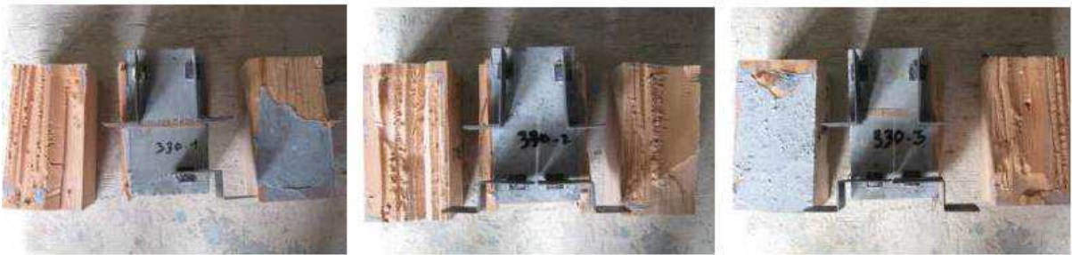
Figure 3-13 : Photos des éprouvettes 330-1, 330-2, et 330-3 (Sikadur 330) après rupture.
