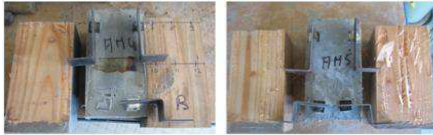
Figure 3-20 : Photos des faciès de rupture des éprouvettes AM4 et AM5 après rupture (acrylique modifiée).
