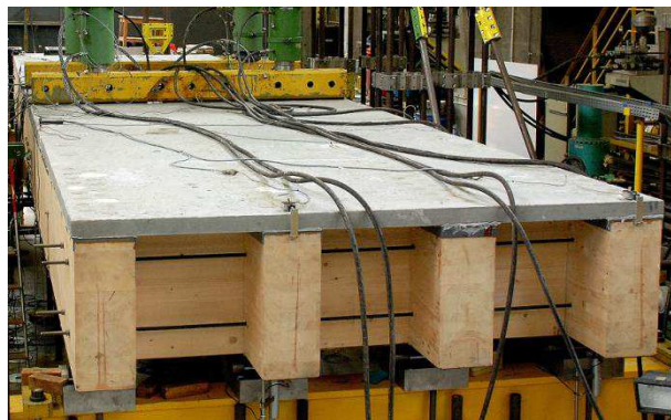
Figure 5-22 : Photo structure mixte bois-béton – tablier NR2C.
