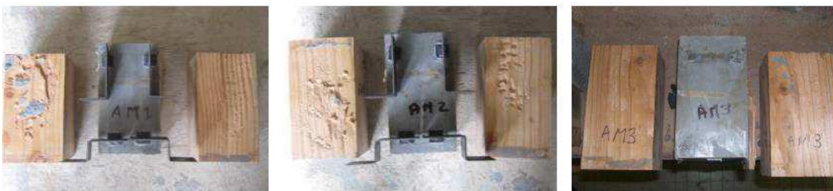
Figure 3-15 : Photos des éprouvettes AM1, AM2, et AM3 (acrylique modifiée) après rupture.
