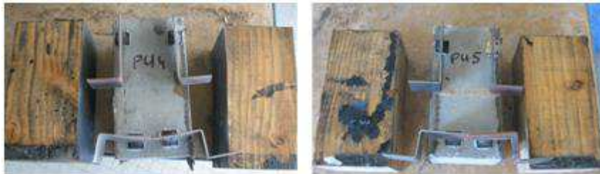
Figure 3-21 : Photos des faciès de rupture des éprouvettes PU4 et PU5 après rupture (polyuréthane bi-composante).
