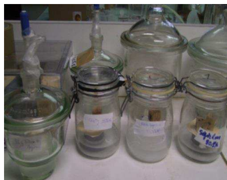
Figure 2-3 : Stockage des échantillons sous humidité relative de l'air contrôlée par des solutions salines dans des dessiccateurs.
