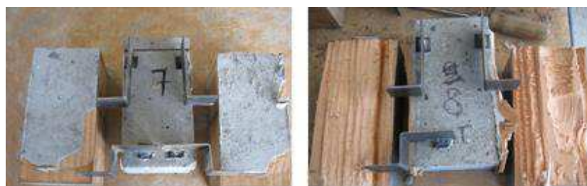
Figure 3-19 : Photos des faciès de rupture des éprouvettes bloc 7 et bloc 8 après rupture (Époxy – Sikadur 330).
