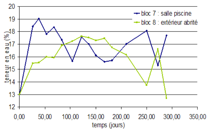
Figure 3-17 : Teneur en eau moyenne des échantillons Bloc7 et Bloc8 en fonction du temps.
