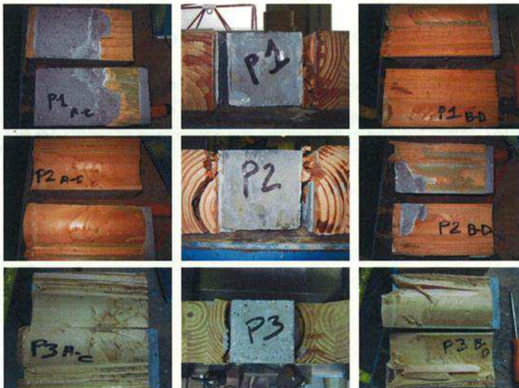
Figure 3-7 : Faciès de rupture des échantillons avec primaire (échantillons P1, P2, P3).
