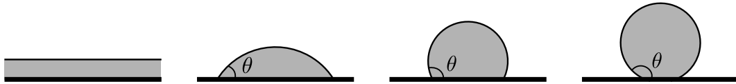
FIGURE 2 – Différents états d'un petit volume liquide sur un substrat, du mouillant (gauche) au non mouillant (droite). \theta définit l'angle de contact.
