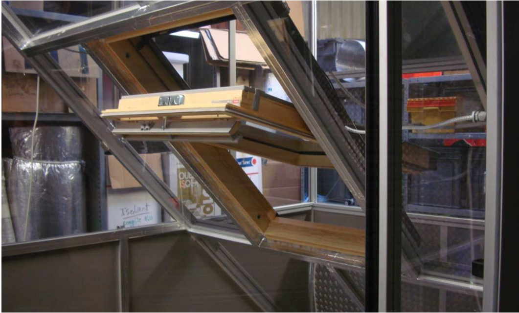
Figure 94 : Fenêtre reliant les deux compartiments de la cellule test
