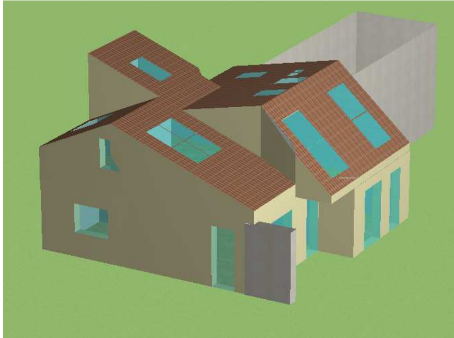
Figure 91 : Représentation avec Alcyone du modèle thermique de la maison Air et Lumière
