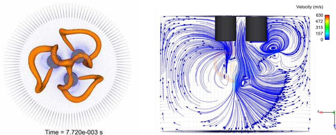
**Figure 115** Comportement des arcs dans la configuration avec des électrodes parallèles, (à gauche) par une vue de dessus et (à droite) par une vue de face avec la trajectoire des particules sur une section suivant Y au centre du domaine.
