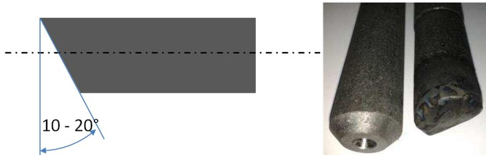
**Figure 92** A gauche, forme schématique de la sublimation des électrodes avec un angle de  $10^\circ$  à  $20^\circ$  après un essai sur le système plasma triphasé. A droite forme des électrodes avant et après un essai sur le dispositif.
