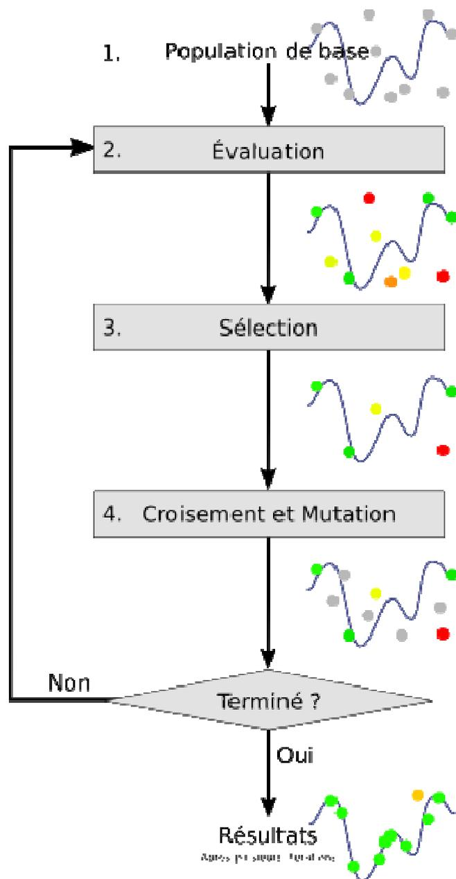
Figure 56 Schéma de principe des algorithmes génétiques – Wikipedia [162]
